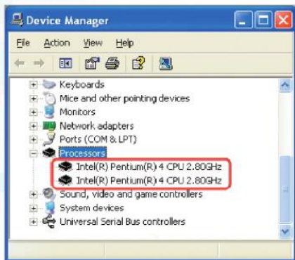
图3.22 超执行绪能把一颗中央处理器模拟成2颗中央处理器以提高处理器执行的效率
