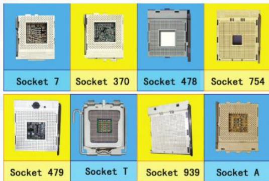
图3.9 各种不同规格的处理器插槽
