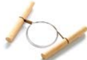
Dawai pemotong Memotong tanah liat.
