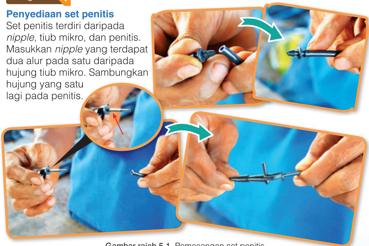
Gambar rajah 5.1 Pemasangan set penitis
