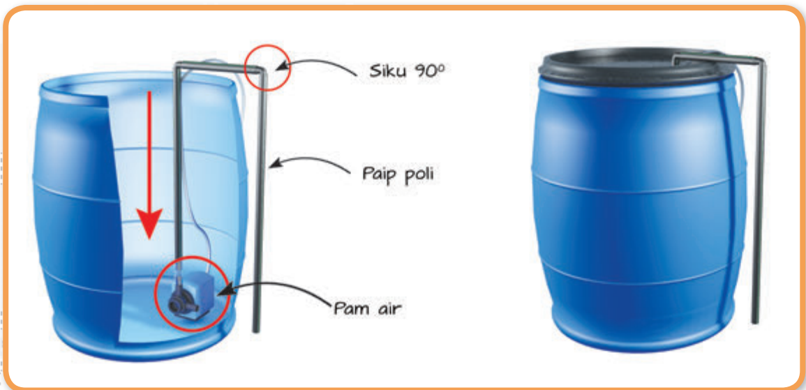
Gambar foto 5.16 Pemasangan pam air ke dalam tangki nutrien
