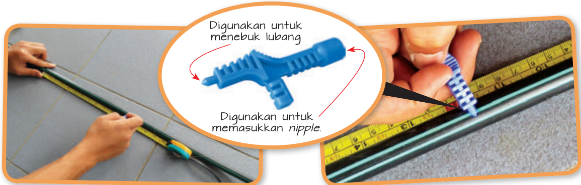
Gambar foto 5.12 Menanda jarak dan membuat lubang nipple
