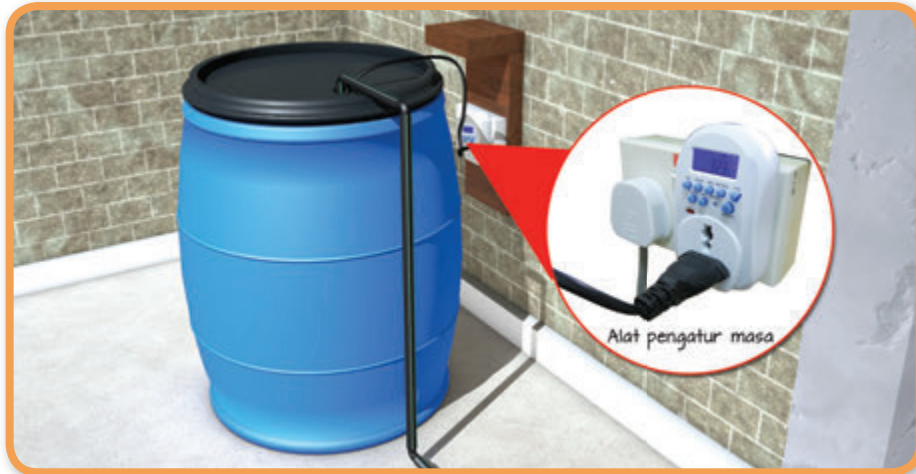
Gambar foto 5.17 Pemasangan pam air pada alat pengatur masa
