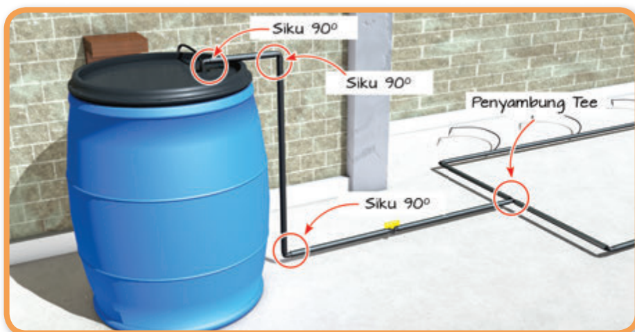
Gambar foto 5.18 Penyambungan sistem pengairan pada tangki nutrien
