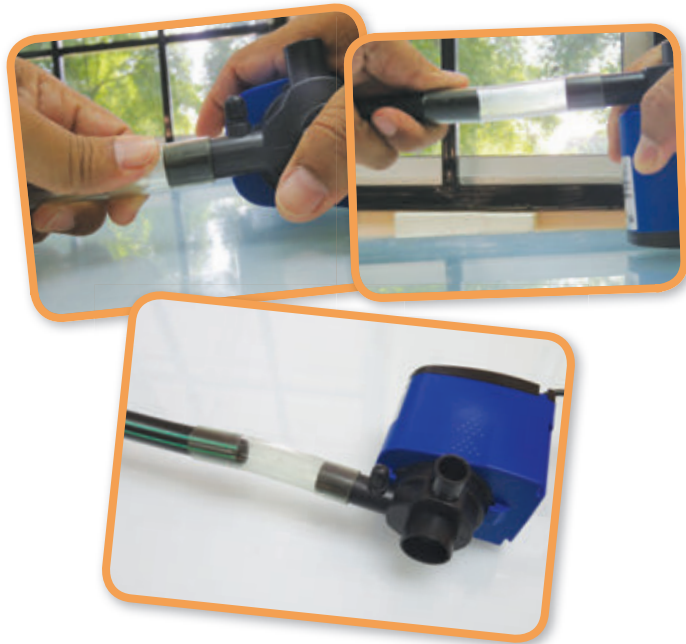
Gambar foto 5.15 Penyambungan tiub lut sinar pada pam air
