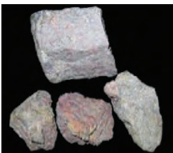
Hematit dan magnetit, bahan mentah yang digunakan dalam aktiviti peleburan besi
