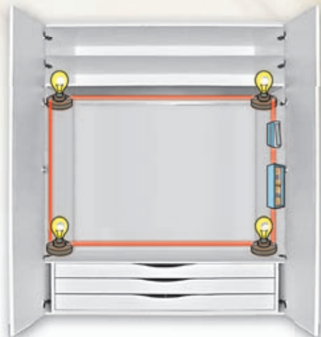
Rajah 2.3.17 Kedudukan gajet elektrik di dalam almari
