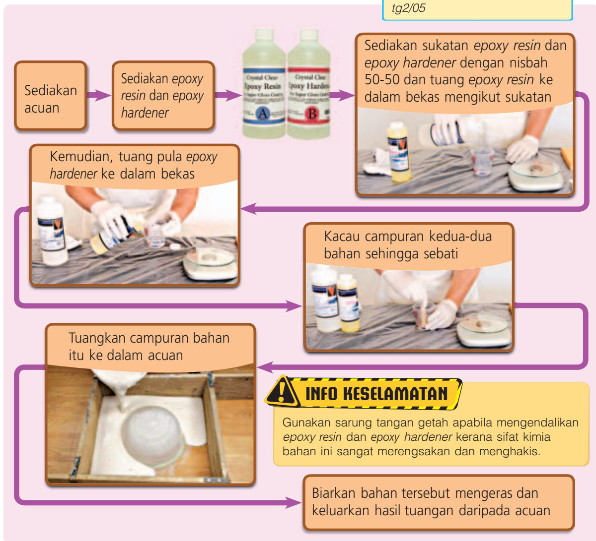
Rajah 2.1.9 Proses tuangan menggunakan epoxy resin dan epoxy hardener
