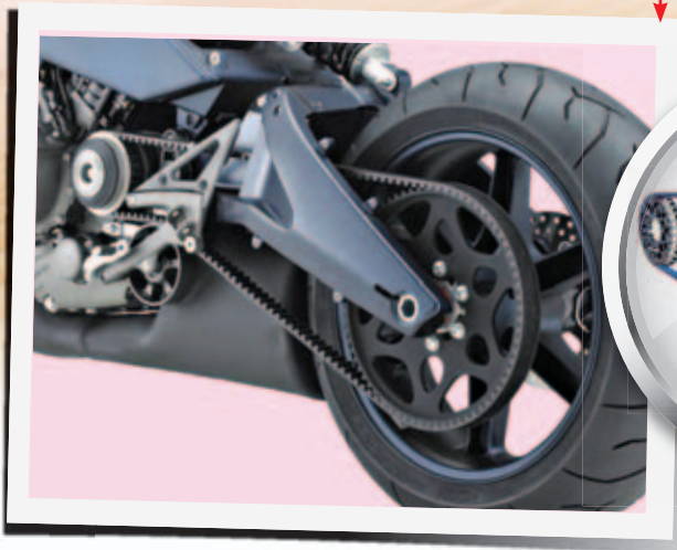
Gambar Foto 2.2.5 Tali sawat pada motosikal
