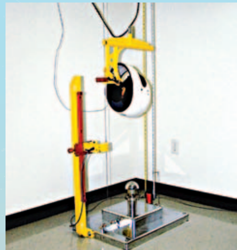
Gambar Foto 2.2.11 Pengujian musnah prototaip dilakukan dengan menggunakan mesin pengujian hentaman
