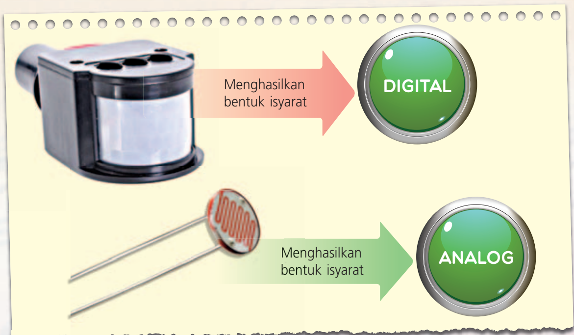
Gambar Foto 2.4.3 Peranti input digital (penderia pergerakan) dan peranti input analog (penderia cahaya)
