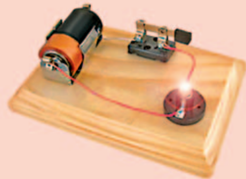
Rajah 2.3.14 Keperluan asas untuk membina sebuah litar elektrik yang lengkap
