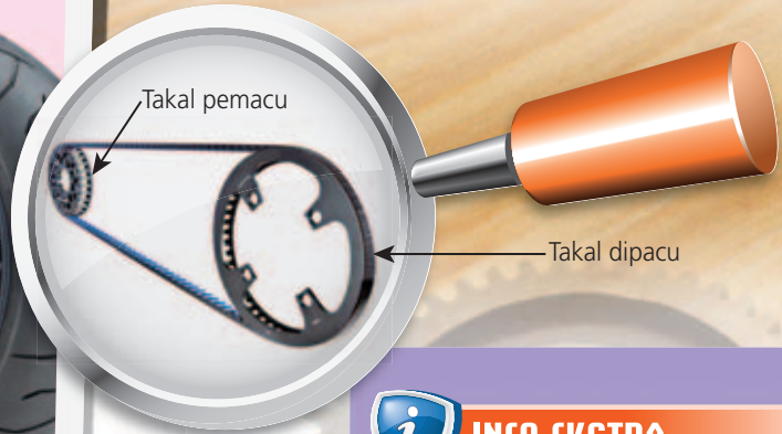
Gambar Foto 2.2.4 Penggunaan takal memudahkan kerja-kerja mengangkat beban yang berat
