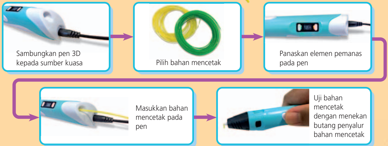
Rajah 2.1.10 Langkah-langkah pemasangan pen 3D
