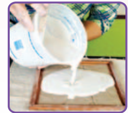
Gambar Foto 2.1.13 Contoh tuangan sejuk menggunakan plaster of paris
