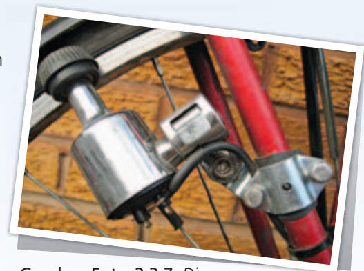
Gambar Foto 2.3.7 Dinamo yang berputar akan menghasilkan arus elektrik
