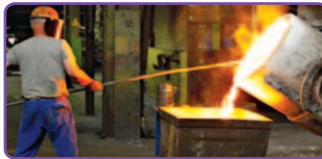
Gambar Foto 2.1.12 Contoh tuangan panas bahan keluli
