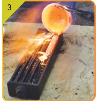
3 Tuangkan cairan perak panas ke dalam acuan besi untuk membentuk jongsong.
