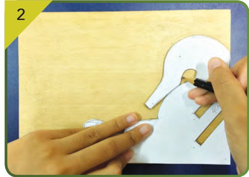
2 Tekap templat kertas berdasarkan ukuran pada lukisan teknikal.
