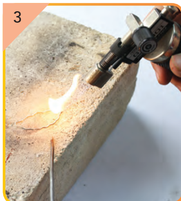
3 Lekatkan hujung dawai bingkai dengan pateri perak melalui proses sepuh.
