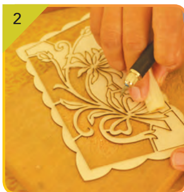
2 Gosokkan lilin pada permukaan corak untuk memudahkan proses menebuk.
