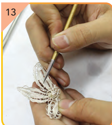
13 Keringkan dan gosokkan rekaan dengan menggunakan besi pengilat.
