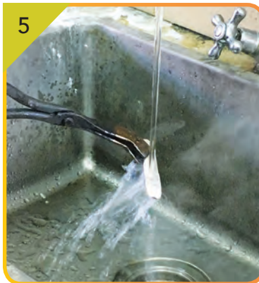
5 Alirkan air pada jongsong perak untuk mempercepat proses penyejukan.
