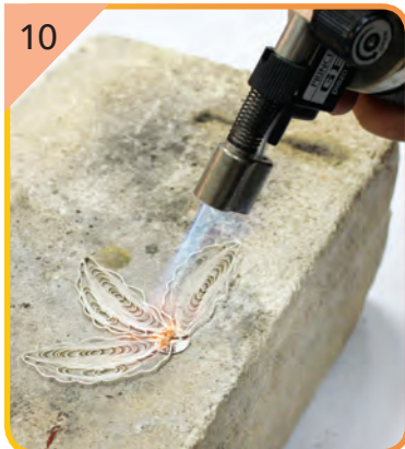
10 Sepuh rekaan untuk mencantumkan rekaan dengan pateri perak.
