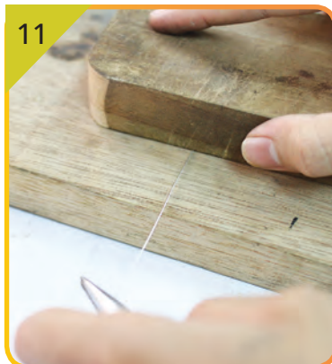
11 Pintal dawai pengisian dengan menggunakan kepingan kayu secara berulang.
