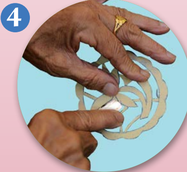
Lilin digunakan untuk melicinkan bahagian tepi mempulur.
