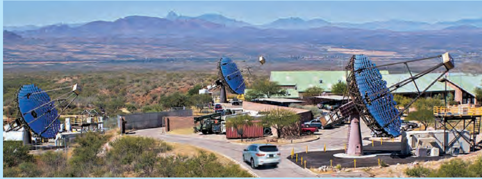
Gambar foto 8.1 Teleskop Cherenkov di Gunung Hopkins, Amerika Syarikat digunakan untuk mengesan sinaran kosmik
