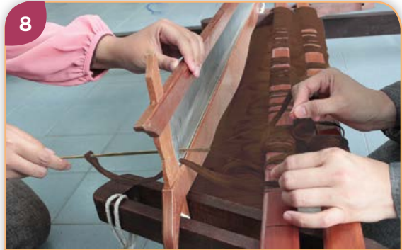
8 Masukkan jarum menyampak melalui gigi jentera (proses menyampak benang).
