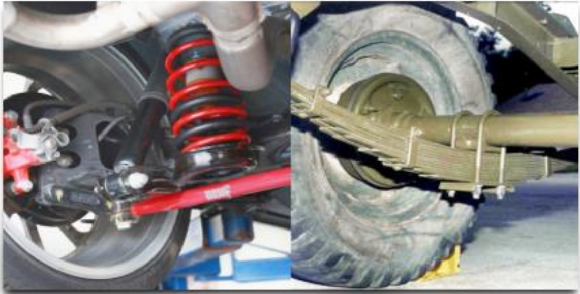
Foto 6.2.5 Kedudukan spring gelung dan spring daun pada kenderaan
