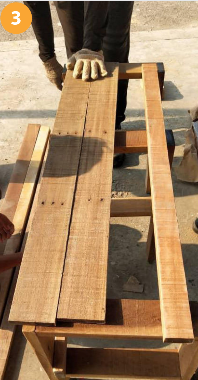
Memasang kayu yang dipotong dengan menggunakan tanggam dan paku. Permukaan kerusi kayu perlu dilicinkan dengan kertas pasir.
