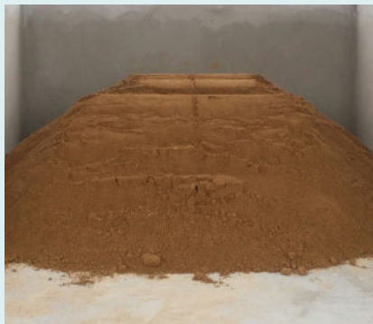
Foto 5.76: Pasir jenis pasir sungai.
