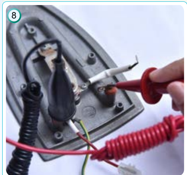
8 Uji penebatan elemen pemanas. Sekiranya bacaan jarum penunjuk penguji tebatan melebihi 0.5MΩ, elemen pemanas dalam keadaan baik.
