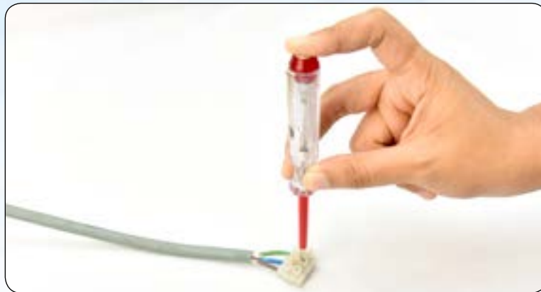
Foto 2.3 Menguji punca Hidup pada wayar terbuka
