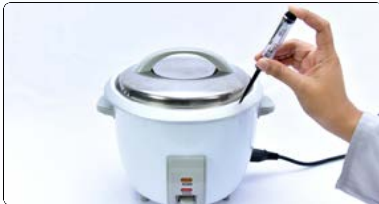
Foto 2.4 Menguji kebocoran arus pada badan peralatan elektrik domestik
