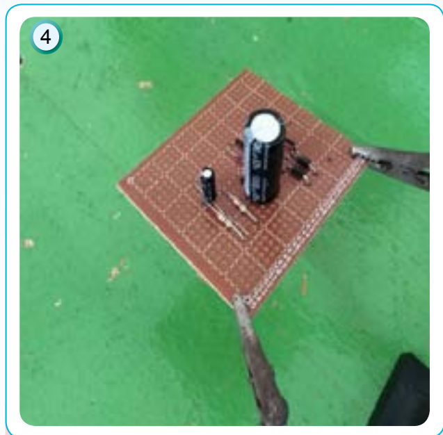
Pasang komponen berpandukan lukisan skematik atau lukisan bergambar.
