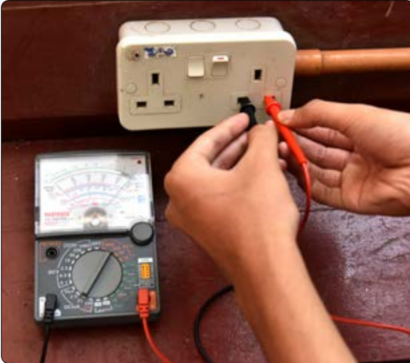
Foto 2.17 Mengukur arus ulang-alik menggunakan meter pelbagai
