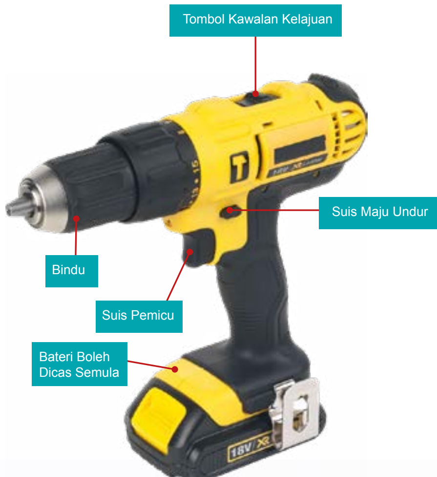
Foto 8.5 Bahagian utama mesin gerudi tangan elektrik
