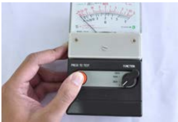
Jadual 2.3 Cara melaraskan penguji tebatan bagi tujuan penebatan
