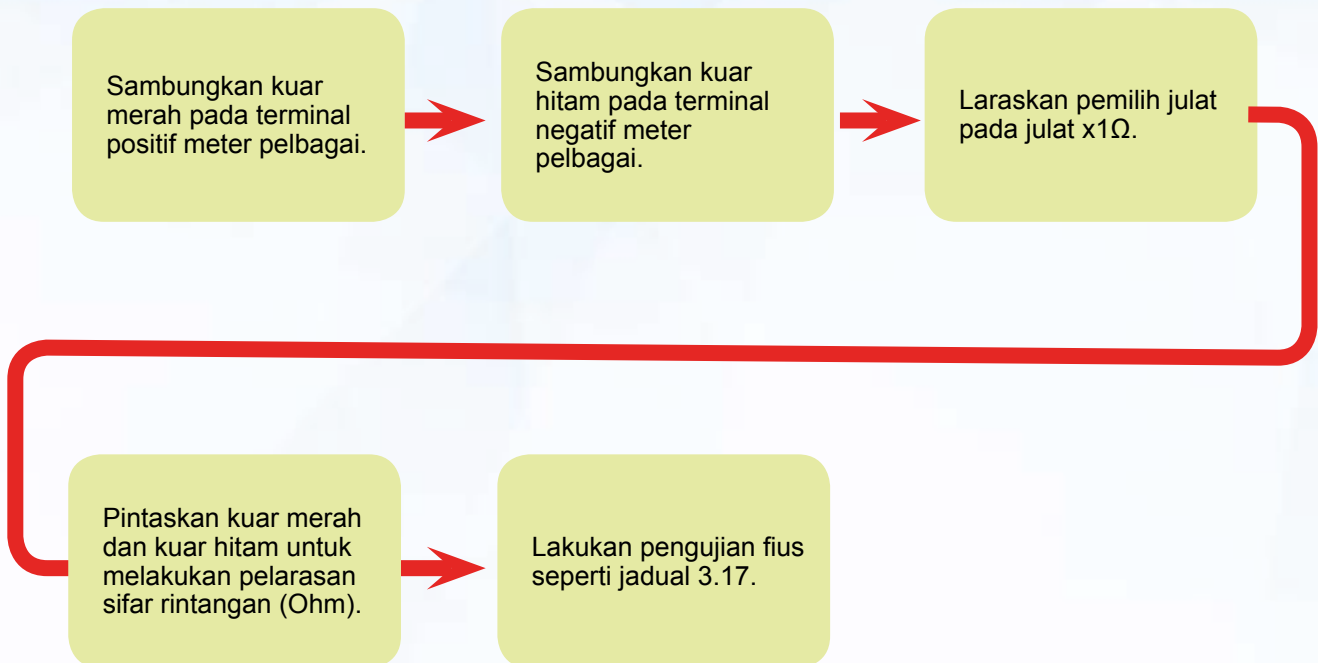
Rajah 3.12 Penyediaan meter pelbagai untuk menguji fius.
