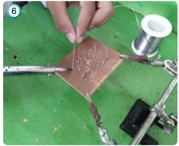
Pateri kaki komponen pada papan litar atau sambungan tamatan komponen.
