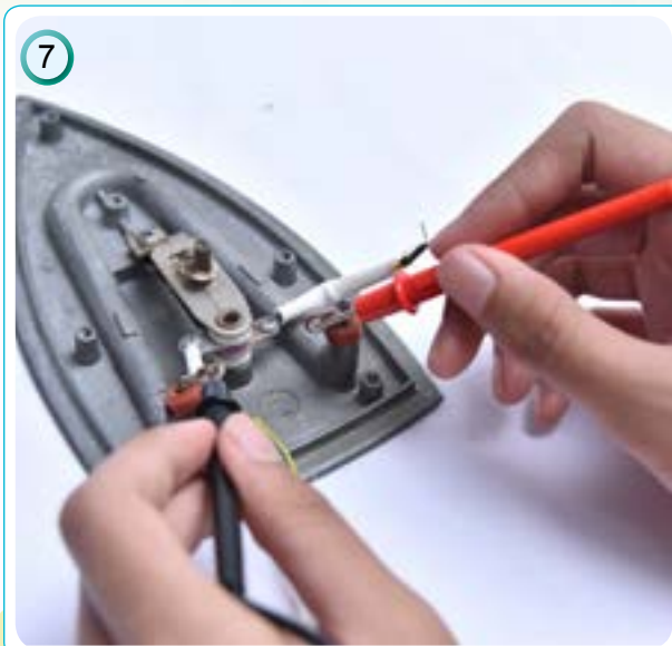
7 Uji keterusan elemen pemanas. Sekiranya jarum penunjuk pada meter pelbagai menunjukkan pesongan, elemen pemanas dalam keadaan baik.
