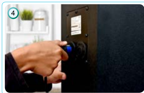
Sambungkan terminal OUT L/R penguat ke terminal INPUT L/R pembesar suara.
