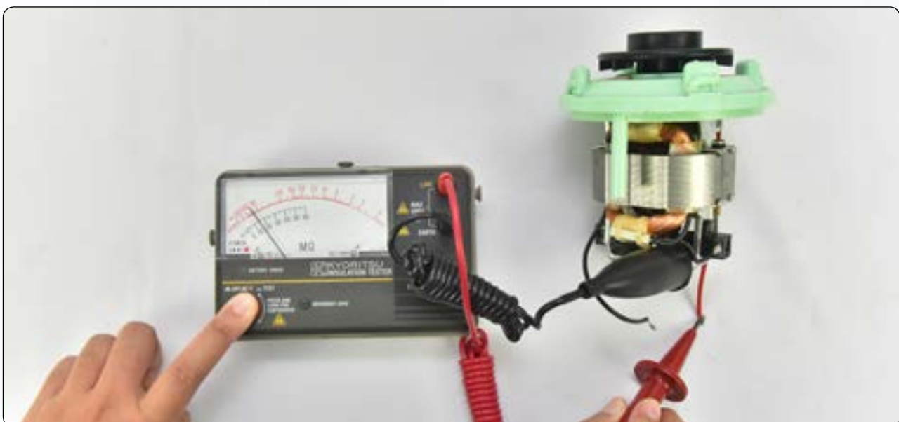
Foto 6.3 Pengujian ketebatan motor AC pengisar menggunakan pengujian tebatan.
