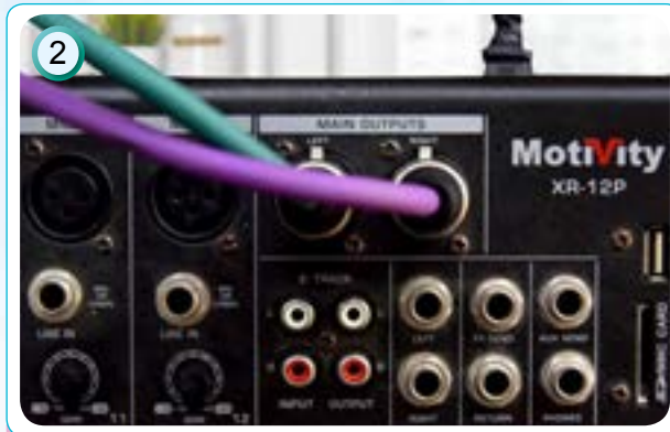
Sambungkan kabel ke tamatan OUT L/R pengadun.
