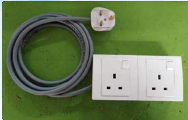
Foto 4.2 Projek kord penyambung tambahan berkembar yang telah siap
