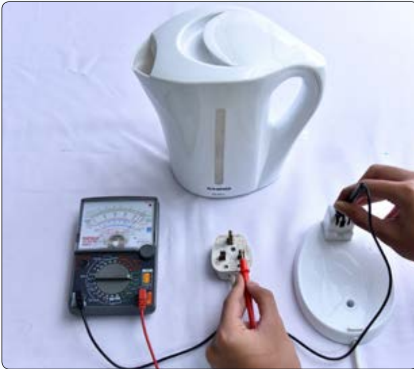
Foto 2.14 Menguji peralatan elektrik menggunakan meter pelbagai
