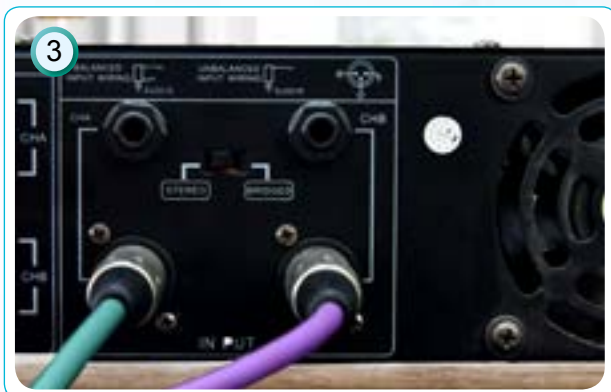
Sambungkan kabel dari tamatan OUT L/R pengadun ke tamatan INPUT L/R penguat.
