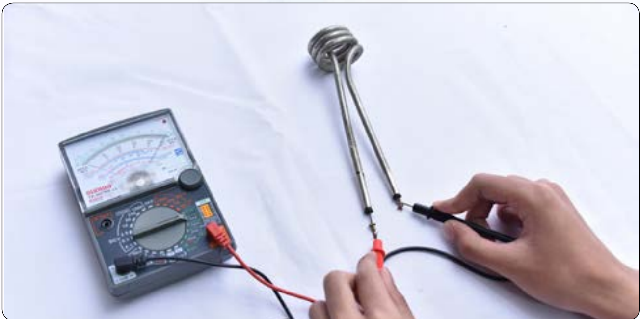
Foto 6.0 Pengujian keterusan elemen pemanas menggunakan meter pelbagai
