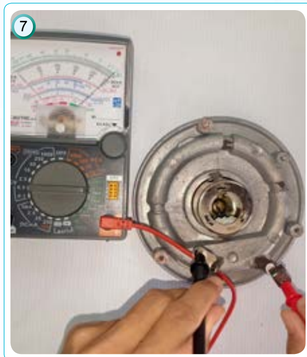
7 Uji keterusan elemen pemanas primer. Jika jarum penunjuk pada meter pelbagai menunjukkan pesongan, elemen pemanas primer dalam keadaan baik.
