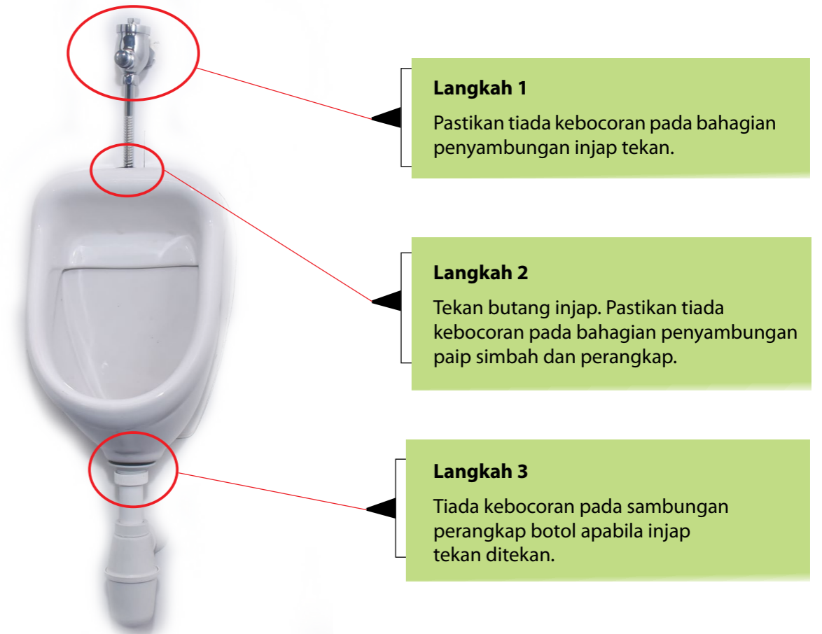
Rajah 6.3 Langkah-langkah menguji kebocoran pada set mangkuk urinal
