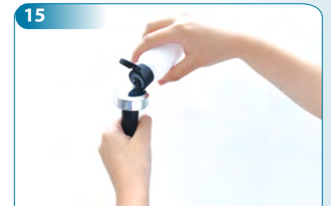
15 Menguji mesin dengan titiskan air di atas probe untuk memastikan mesin berfungsi. Setkan masa selama 10 minit.
