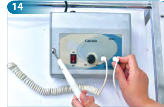
14 Menyambung hujung wayar elektrod aktif ke mesin galvanik. Laraskan mesin galvanik pada tanda negatif.
