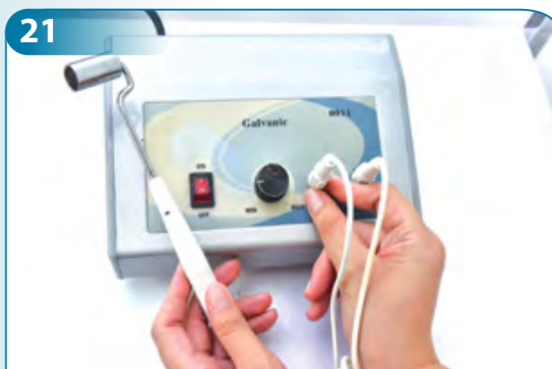
21 Menyambung hujung wayar elektrod aktif ke mesin galvanik pada tanda positif.
