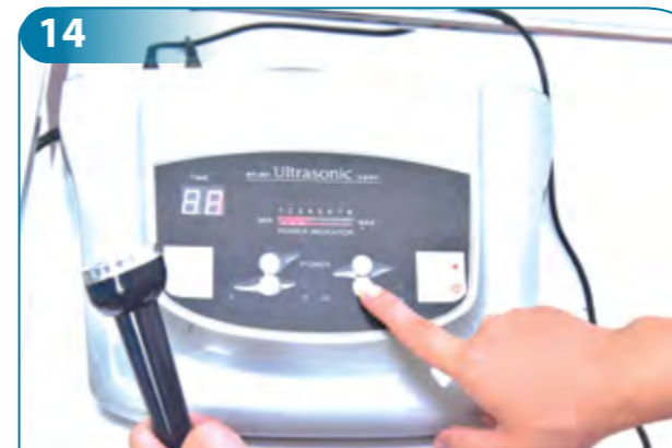
14 Melaraskan kekuatan arus sehingga 3 MHz dan pilih jenis arus sequence atau pulse .
