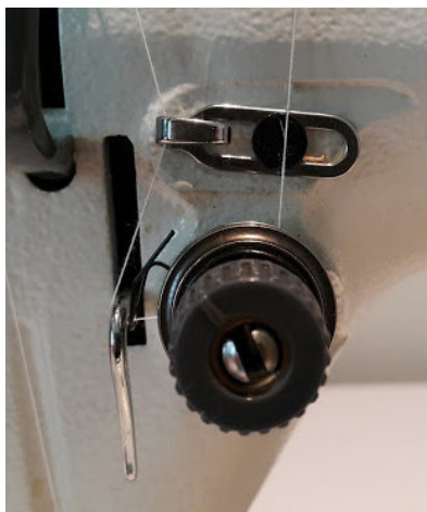
Langkah 5 Lalukan benang pada alur benang.
