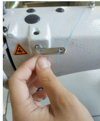
Langkah 3 Masukkan benang ke alur benang.
