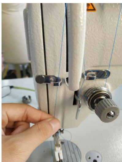
Langkah 7 Lalukan benang ke dalam lubang tuas pemegang benang.
