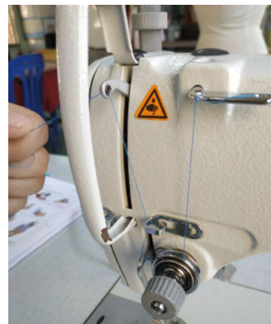
Langkah 6 Masukkan benang ke dalam lubang tuas pemegang benang.
