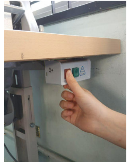
Langkah 6 Selesai menggunakan mesin, tekan butang Off pada suis di bahagian meja mesin. Matikan suis pada soket plag utama.
