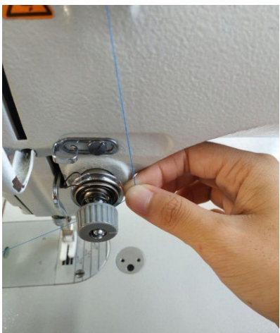
Langkah 4 Lalukan benang pada ceper pemegang benang.
