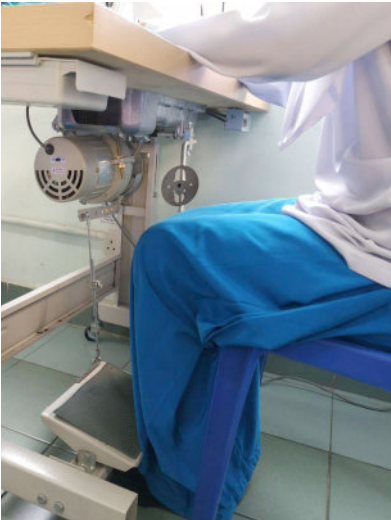
Langkah 4 Biarkan mesin seketika lebih kurang 5 ke 10 saat. Pastikan kaki tidak diletakkan di pedal pada ketika ini.
