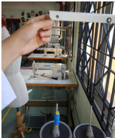
Langkah 1 Letakkan buku benang pada tiang benang. Pasang benang pada lubang alur benang di tiang benang.
