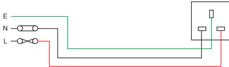
Rajah 3.39 Lakaran litar skematik soket alir keluar 3 pin 13A
