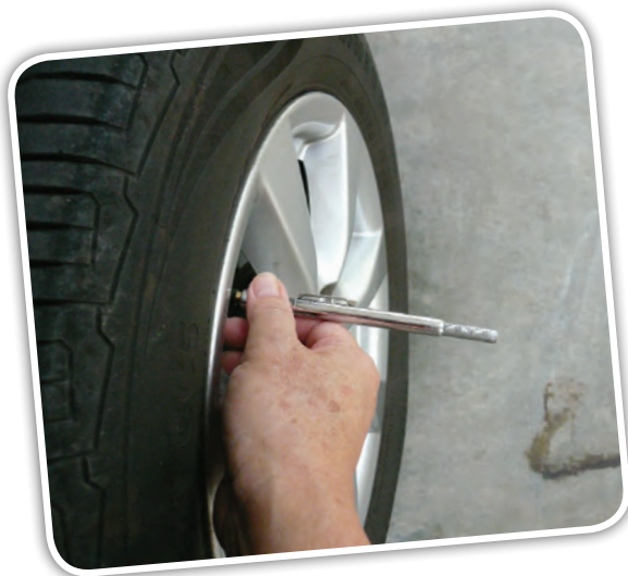
Gambar foto 4.6 Tekanan udara tayar kereta diukur
