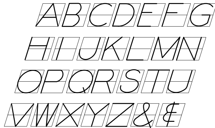
Rajah 1.29 Huruf condong piawai ditulis pada sudut 60° hingga 75° pada garisan panduan dengan saiz, tinggi dan lebar seragam.
