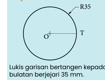
Rajah 2.73 Kaedah melukis garisan bertangen kepada bulatan apabila titik berada pada lilitan bulatan.
