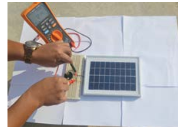
Foto 2.5 Pengujian litar penuaian tenaga boleh baharu menggunakan perkakasan.
