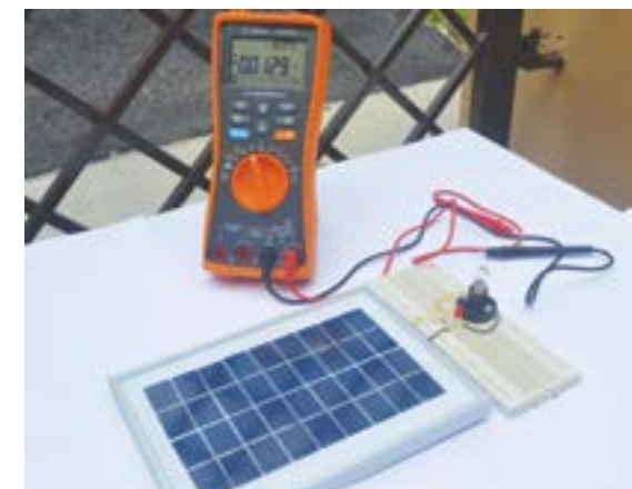
Foto 2.4 Contoh pemasangan litar penuaian tenaga boleh baharu di atas papan reka.
