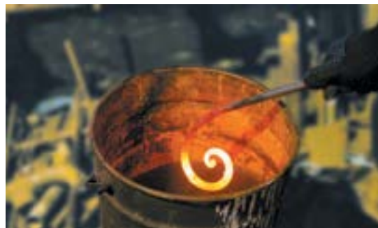
Foto 2.23 Aloi disejukkan dalam media seperti minyak atau air
