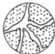
Mikrostruktur austenit + simentit
