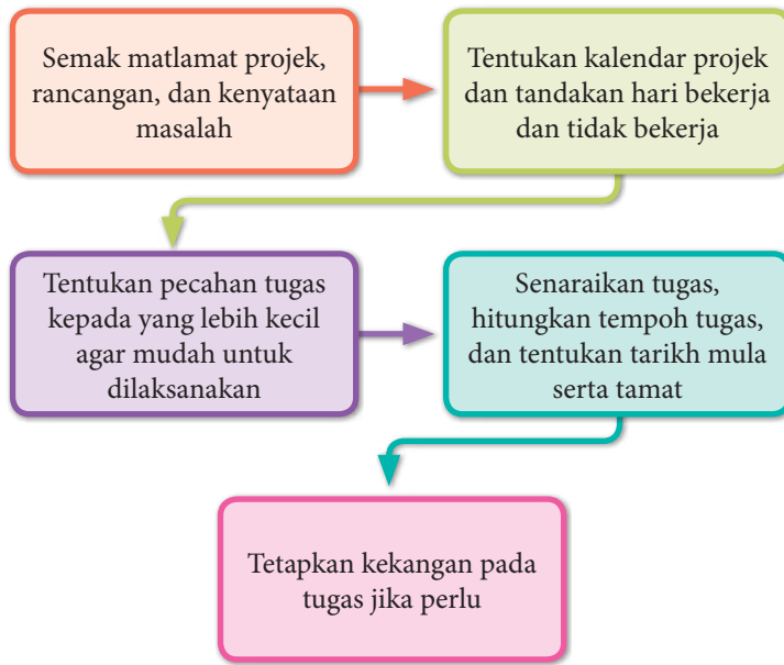
Rajah 4.10 Langkah-langkah semasa membina Carta Gantt
