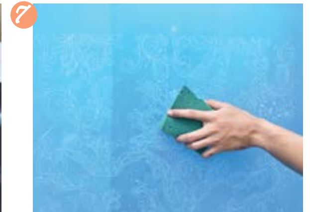
➤ Gosok kedua-dua belah permukaan skrin dengan span yang dibasahkan dengan air untuk mengeluarkan corak.
