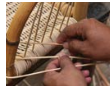
14 Pada bahagian tepi dan belakang rak dinding, anyaman dilakukan dengan menggunakan tiga bilah rotan.
