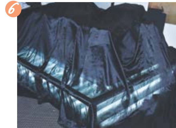
➤ Letakkan film corak di atas permukaan meja dedahan cahaya, kemudian tindihkan dengan skrin yang telah disapu photo emulsion diikuti dengan pemberat supaya skrin rapat dengan film corak.
