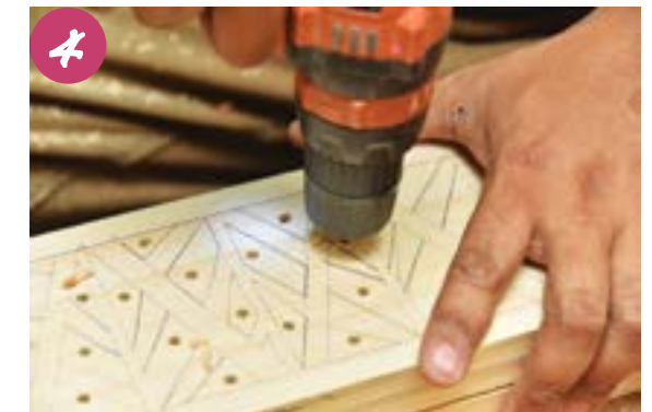
Tebuk bahagian yang hendak dibuang dengan menggunakan handrill .
