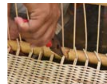
12 Patah dan selitkan rotan yang telah dipotong.
