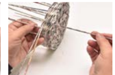
9 Setelah mencapai ketinggian satu inci batang bilah ditambah untuk menganyam ceper lampu.
