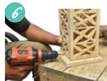
6 Tebuk lubang di tepi tapak lampu untuk memasukkan wayar.
