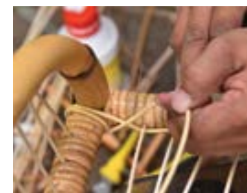
8 Bilah rotan dililit sebanyak dua kali pada hujung rangka rak dinding.
