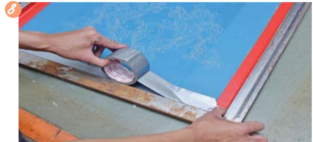
➤ Gunakan pita perekat untuk menutupi bahagian tepi skrin supaya proses mencetak akan menjadi lebih kemas dan bersih.
