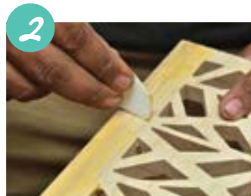
2 Sapukan woodfiller pada kesan cantuman sebagai kemas.
