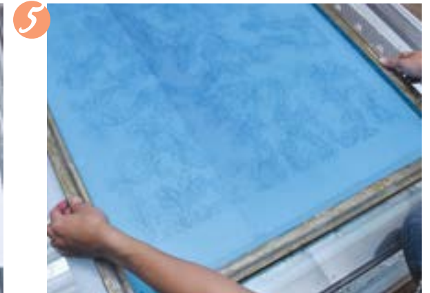
➤ Dedahkan dengan cahaya lampu di antara lima hingga enam minit.
