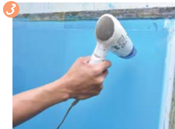
➤ Keringkan photo emulsion yang disapu di atas bingkai dengan pengering rambut di dalam bilik gelap.
