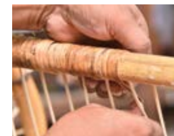
6 Sebelum memulakan anyaman, rotan dililit pada bahagian hadapan rangka rak dinding.
