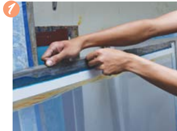
➤ Pasangkan polyester mesh di atas bingkai kayu atau besi.
