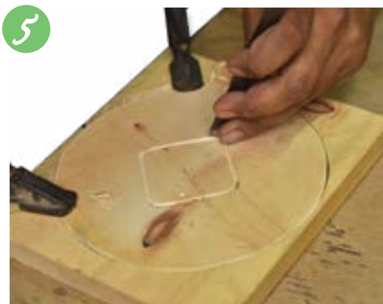
Pahat di belakang muka jam untuk memasukkan motor jam.
