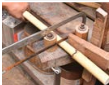
1 Batang rotan dipotong mengikut ukuran yang dikehendaki.
