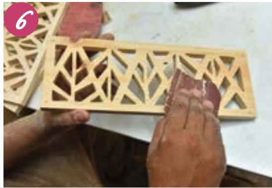
6 Gosok permukaan kayu dengan kertas pasir untuk menghilangkan kesan potongan.
