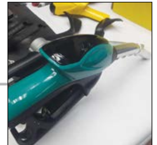
Contoh model akhir hasil daripada mesin pencetak 3D yang telah dibuat kemasan akhir
