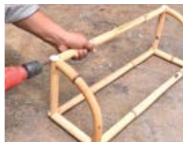
2 Batang rotan dicantum menjadi rangka rak dinding.
