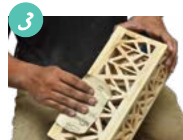
3 Gosokkan permukaan kayu dengan kertas pasir untuk menghilangkan kesan woodfiller.
