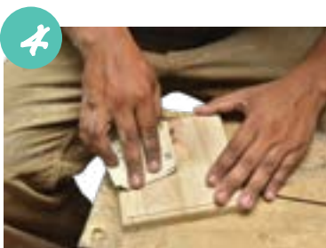
4 Licinkan tapak lampu dengan menggunakan kertas pasir.
