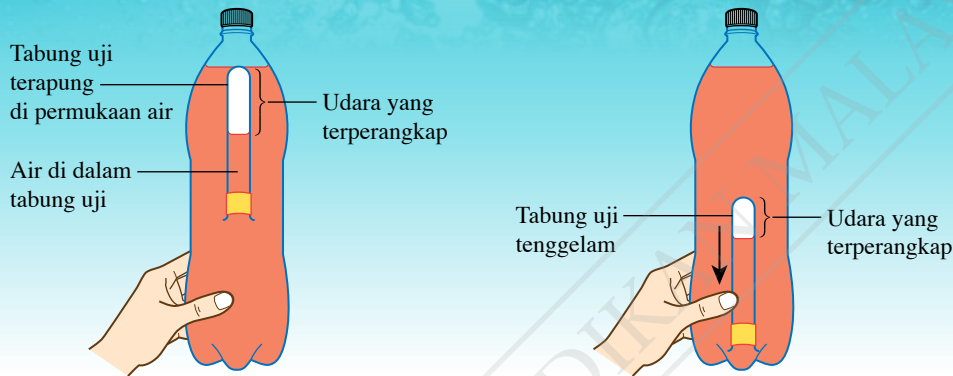
(a) Tabung uji terapung di permukaan air (b) Tabung uji tenggelam ke dalam air
