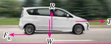
Rajah 1.6 Daya-daya yang bertindak pada objek dalam keadaan gerakan yang berbeza
