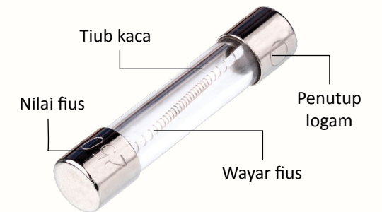
Gambar foto 7.5 Struktur fius
