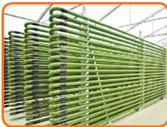
Gambar foto 3.11 Loji mikroalga yang digunakan dalam Teknologi Emisi Negatif
