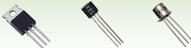
Gambar foto 1.2.1 Bentuk fizikal transistor kesan medan
