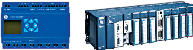
Gambar foto 2.2.2 Contoh pengawal logik boleh atur cara (PLC)
