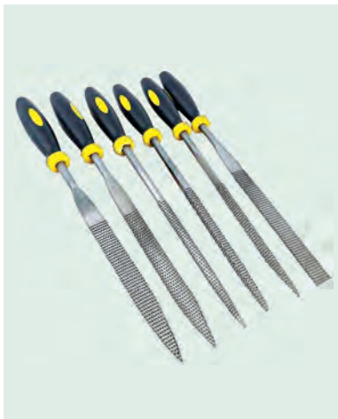
Gambar foto 5.2.4 Pelbagai jenis kikir digunakan untuk melakukan kerja mengikir
