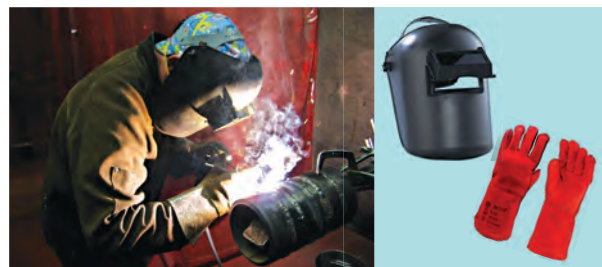
Gambar foto 5.3.12 Pakaian dan peralatan perlindungan yang khusus semasa melakukan kerja kimpalan
