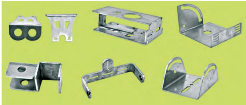
Gambar foto 5.4.17 Contoh produk yang dihasilkan melalui proses pembengkokan
