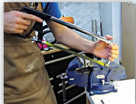
Gambar foto 5.2.2 Kaedah memegang gergaji tangan semasa memotong benda kerja pada ragum meja
