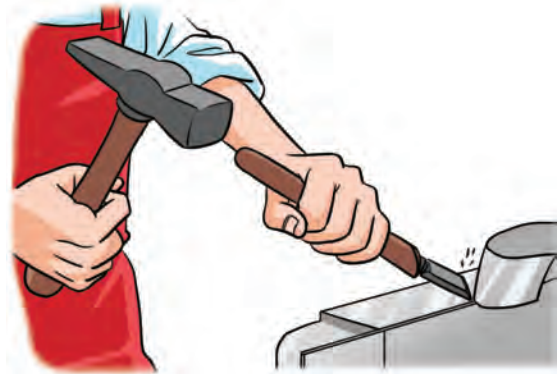
Rajah 5.2.4 Menyerpih logam menggunakan pahat
