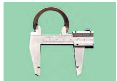
Gambar foto 5.1.7 Mengukur diameter bahagian dalam bahan kerja
