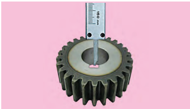
Gambar foto 5.1.8 Mengukur kedalaman bahan kerja
