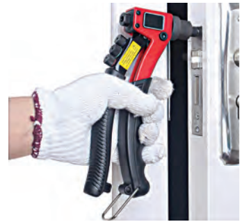
Gambar foto 5.3.13 Gunakan sarung tangan semasa merivet
