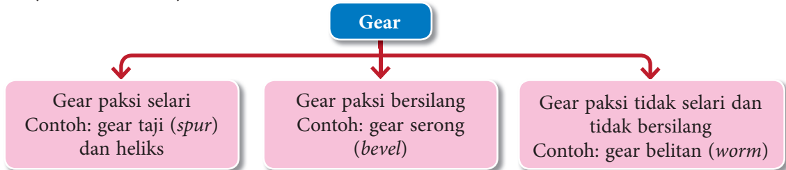
Rajah 6.1.2 Klasifikasi dan orientasi paksi gear
