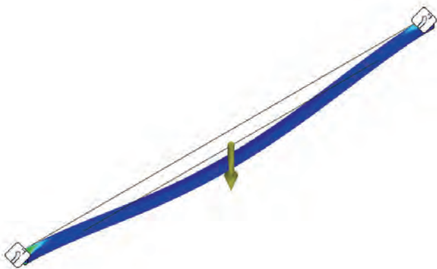
Rajah 7.2.14 Pengujian kekuatan produk menggunakan perisian Autodesk Inventor 2020
