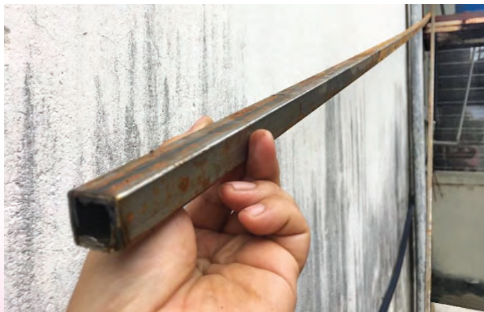
Gambar foto 7.2.20 Bahan kerja terdedah kepada suhu dan kelembapan menyebabkannya berkarat
