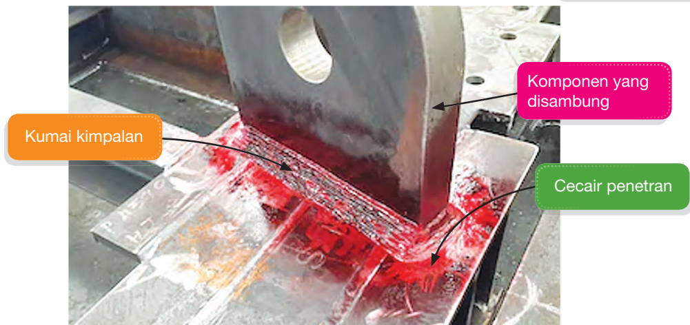
Gambar foto 7.2.10 Ujian tanpa musnah kaedah dye penetrant komponen yang dikimpal
