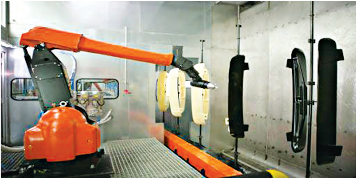
Gambar foto 7.2.25 Menggunakan teknologi robot untuk mengecat
