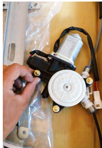
Gambar foto 7.2.12 Contoh kerja-kerja pemasangan motor power window
