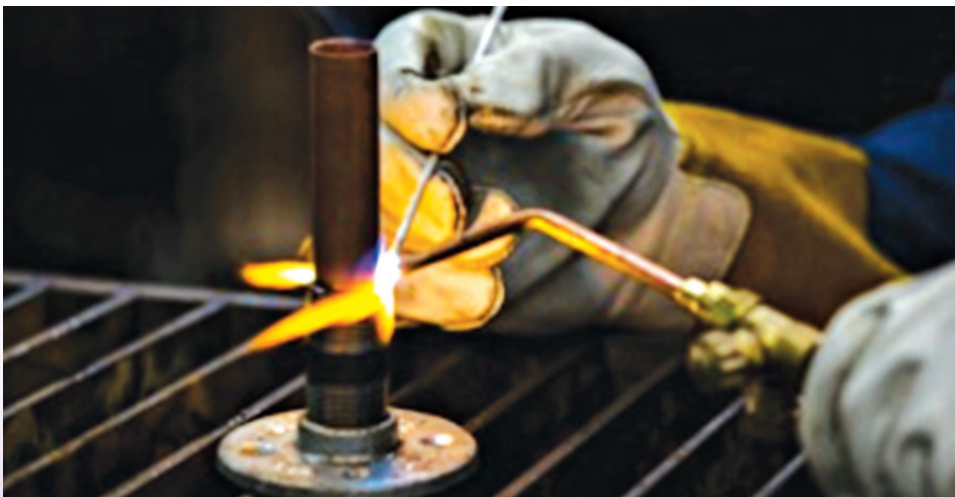
Gambar foto 7.2.18 Kaedah sambungan kimpalan gas oksi-astelina yang kurang sesuai
