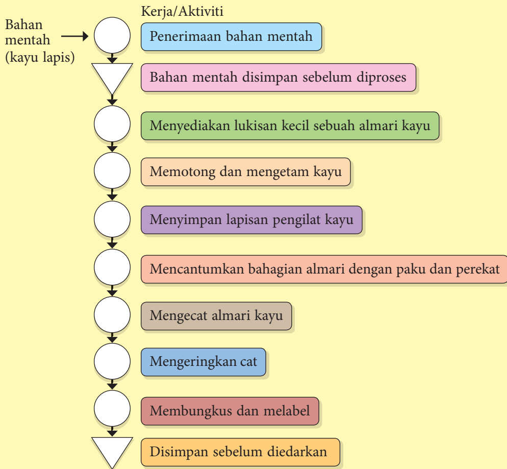
Rajah 4.2.10 Rajah skematik proses pengeluaran almari kayu
