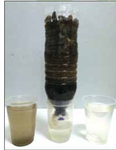
Foto 2.19 Hasil sebelum dan selepas air melalui sistem penapisan
