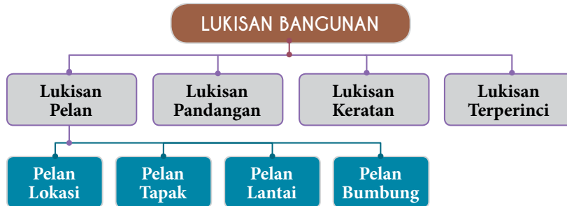
Rajah 4.1.2 Elemen dalam lukisan bangunan.
