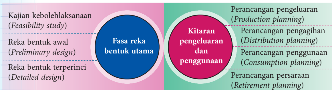
Rajah 7.1.1 Morfologi reka bentuk yang menunjukkan terdapat tujuh fasa dalam reka bentuk produk (Morris Asimow, 1962)
