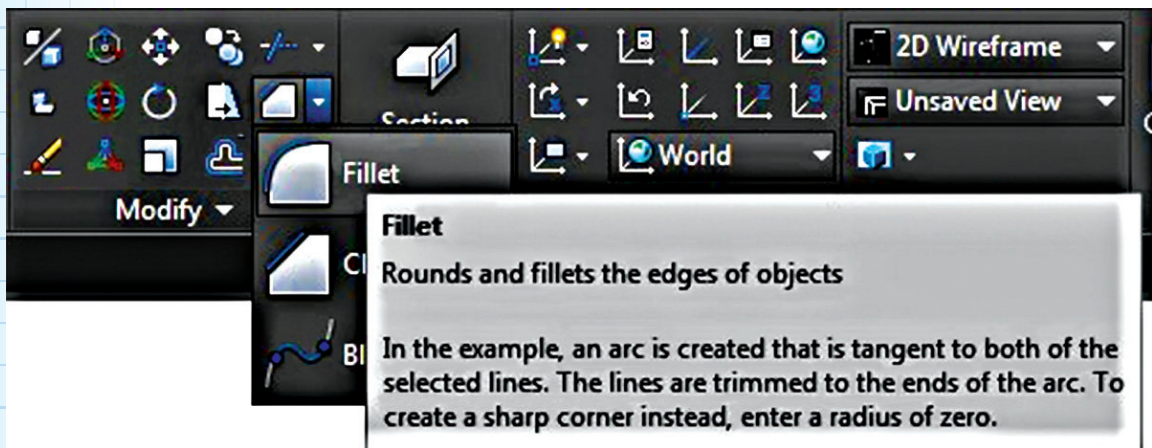
Rajah 6.3.3 Simbol arahan Fillet pada paparan AutoCAD
