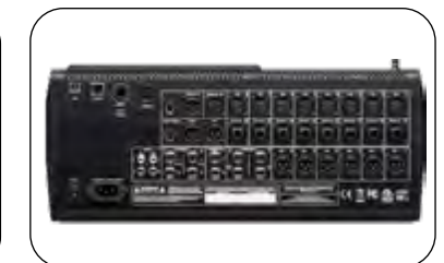
Foto 1.10 Contoh audio interface yang mempunyai 4 – 6 I/O
