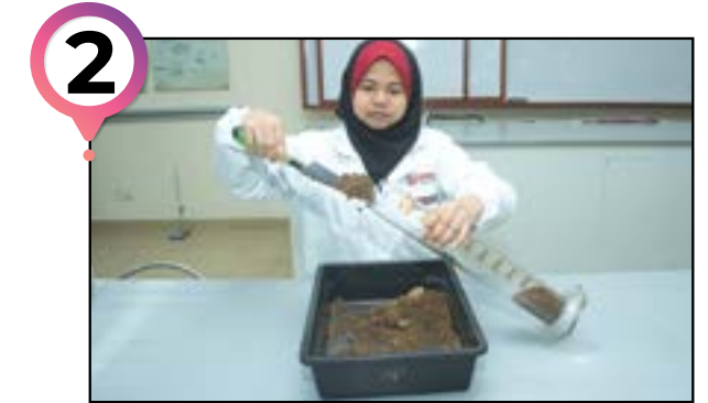
Masukkan sampel tanah ke dalam balang gas satu perempat penuh.
