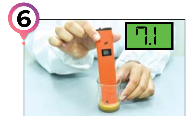
Dapatkan bacaan pH dengan memasukkan meter pH dan catatkan nilai bacaan. Ulangi langkah pada sampel tanah yang lain.
