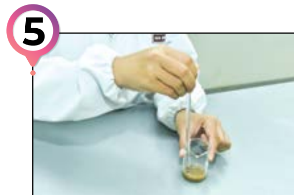
Masukkan 10 g sampel tanah dan 10 ml air suling ke dalam bikar. Kacau hingga sehati.
