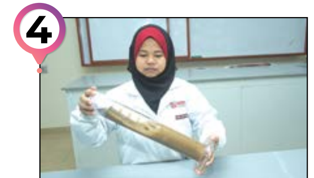
Goncang balang gas hingga partikel tanah terampai dan biarkan tanpa gangguan semalam.
