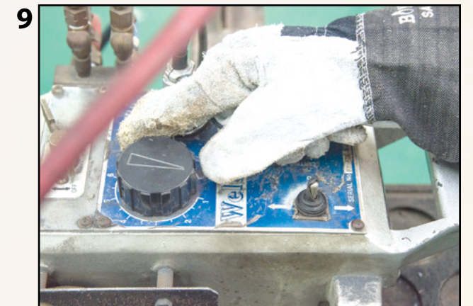
Tetapkan jarak garisan panduan pemotongan supaya selari dengan landasan. Pastikan orifis gas Oksigen pemotongan pada muncung sumpitan api berada di luar garisan panduan.
