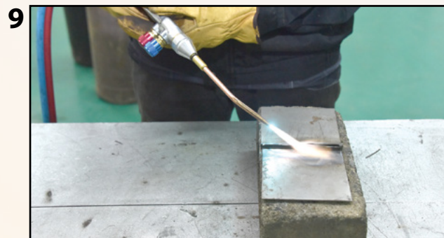
Pastikan sudut muncung sumpitan api berada pada kedudukan di antara 40° hingga 45° sebelum memulakan proses mengimpal.
