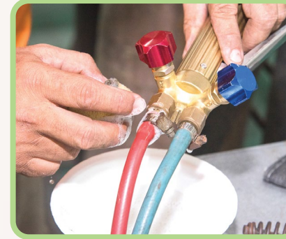
Foto 5.19 Menguji kebocoran pada penyambungan hos Oksigen dan Asetilena.
