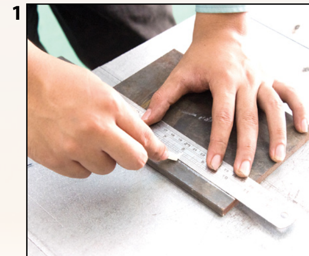
Tandakan garisan panduan pemotongan menggunakan kapur kejuruteraan mengikut ukuran yang telah ditetapkan.
