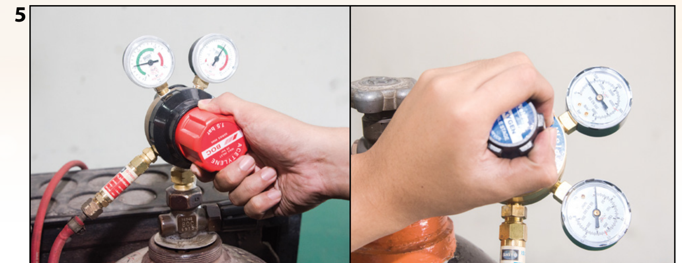
5 Laraskan pada tekanan yang sesuai iaitu 26 psi bagi gas Oksigen dan 6 psi bagi gas Asetilena.
