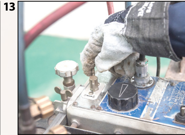
Buka injap gas Oksigen dan hidupkan suis bekalan kuasa mesin pemotongan.
