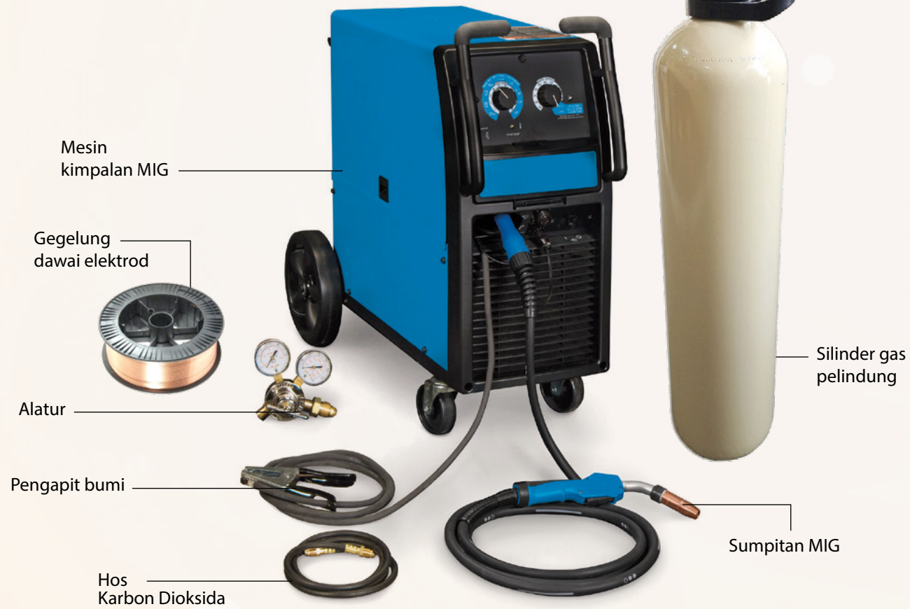
Rajah 6.5 Kelengkapan mesin kimpalan MIG
