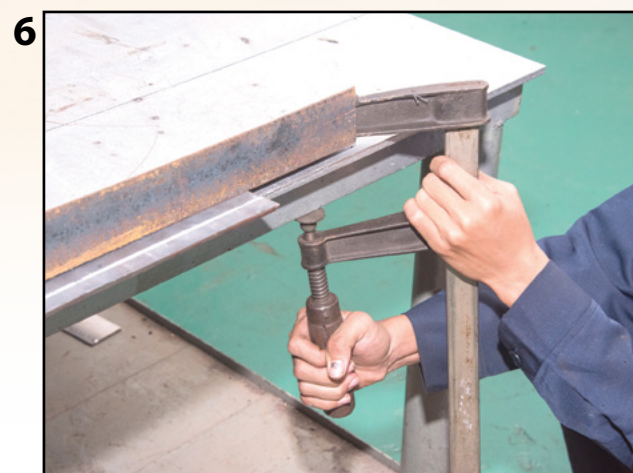
Letakkan kepingan plat di atas meja kerja pada kedudukan yang rata.
