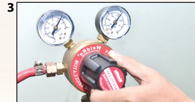
Laraskan tekanan gas Asetilena dan gas Oksigen antara dua hingga tiga psi pada alatur.
