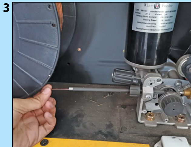
Memasukkan dawai suapan ke dalam unit suapan dawai elektrod.
