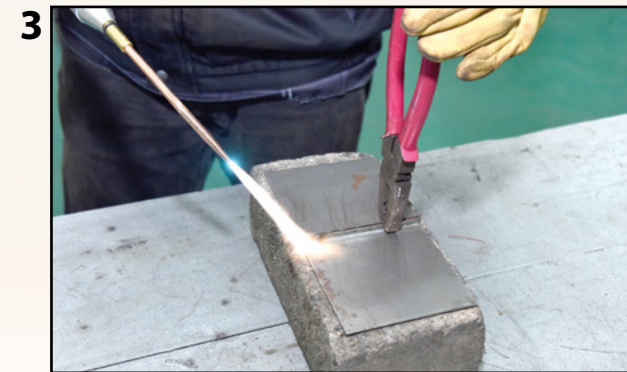
Cantumkan kedua-dua bahagian yang telah dilipat. Kimpal paku pada permukaan yang dilipat.
