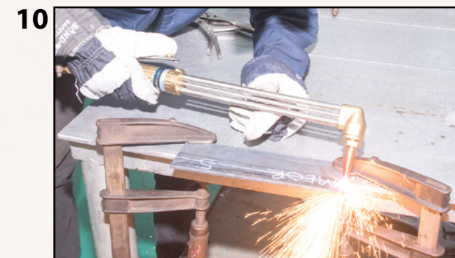
Pastikan tip pemotong berada di antara sudut 30° - 35° kemudian tekan tuil penekan pemotongan untuk proses pemotongan.
