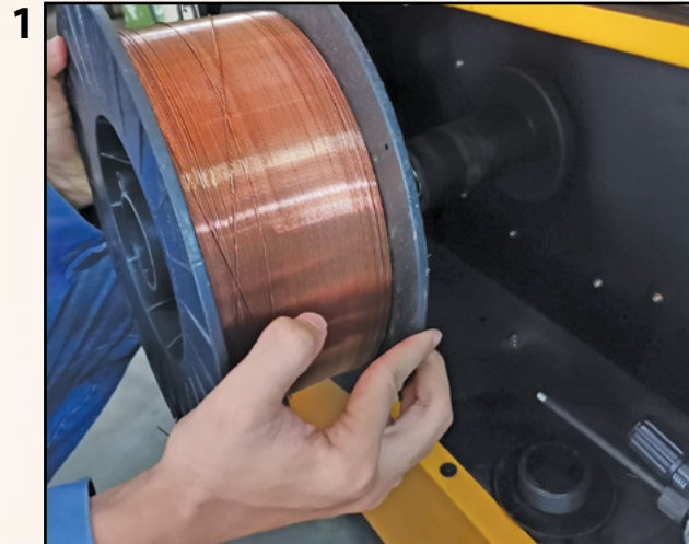
Memasukkan gegelung dawai suapan ke dalam ruang yang telah ditetapkan.
