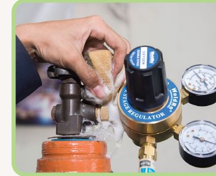
Foto 5.20 Menguji kebocoran pada penyambungan alatur Oksigen.
