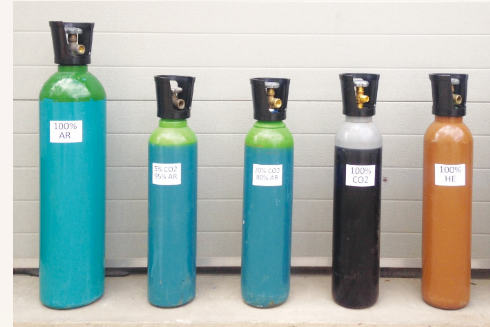
Foto 6.4 Silinder gas pelindung
