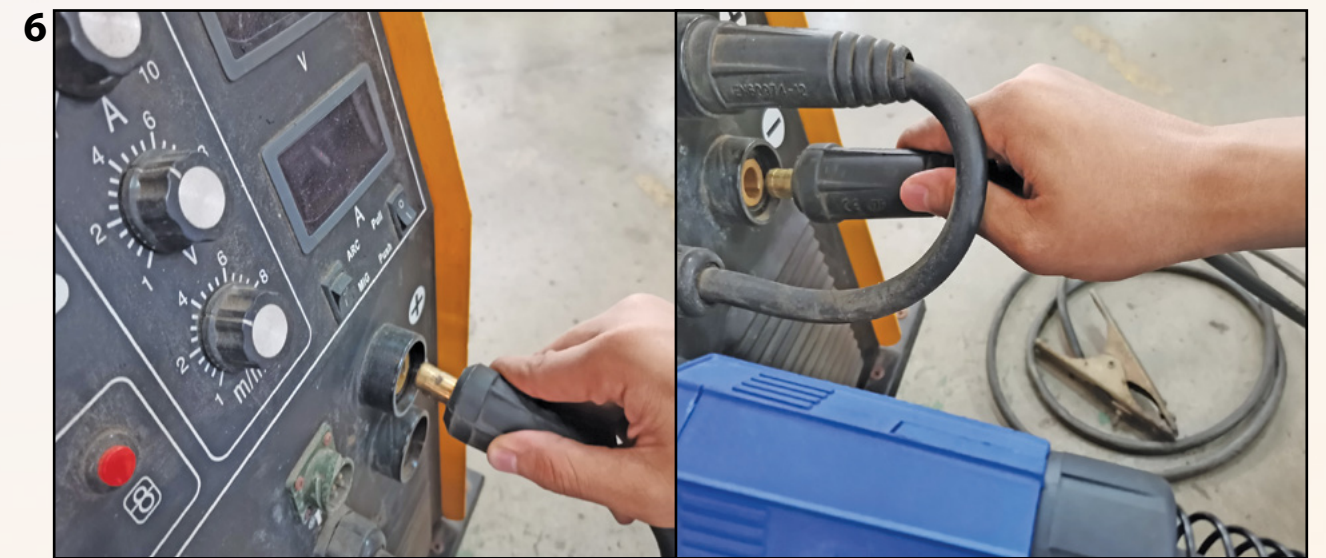
Memasang kabel elektrod dan kabel bumi pada mesin.
