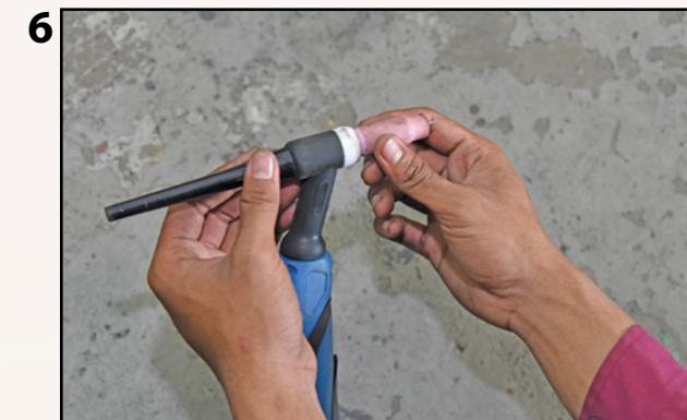
Memasang cawan gas bersaiz 5 atau 6 pada badan kolet.
