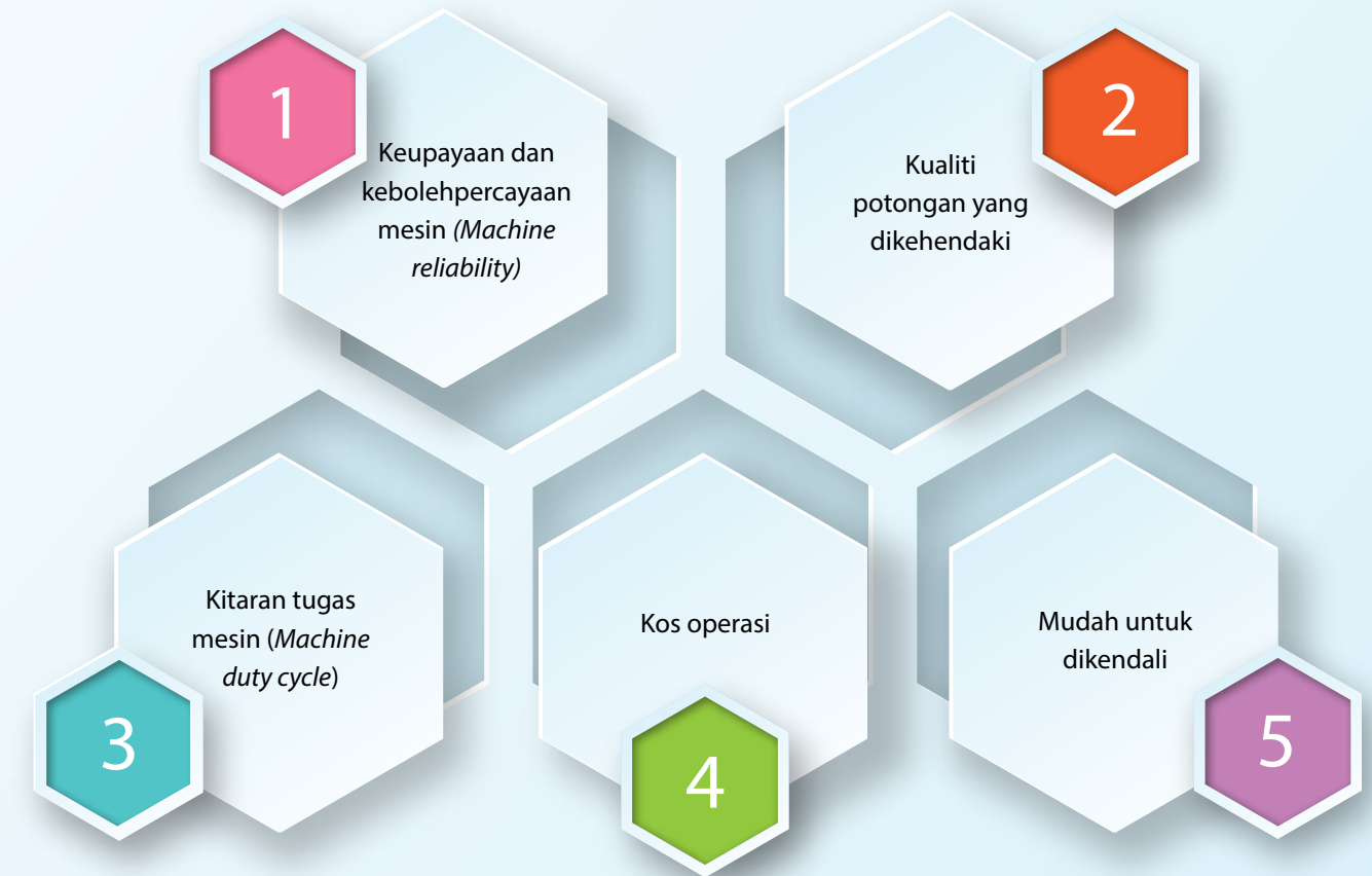
Rajah 4.6 Faktor yang mempengaruhi pembelian peralatan pemotongan plasma
