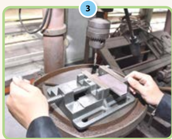
3 Apitkan kepingan logam dengan ragum gerudi dan letakkan di atas meja kerja gerudi.
