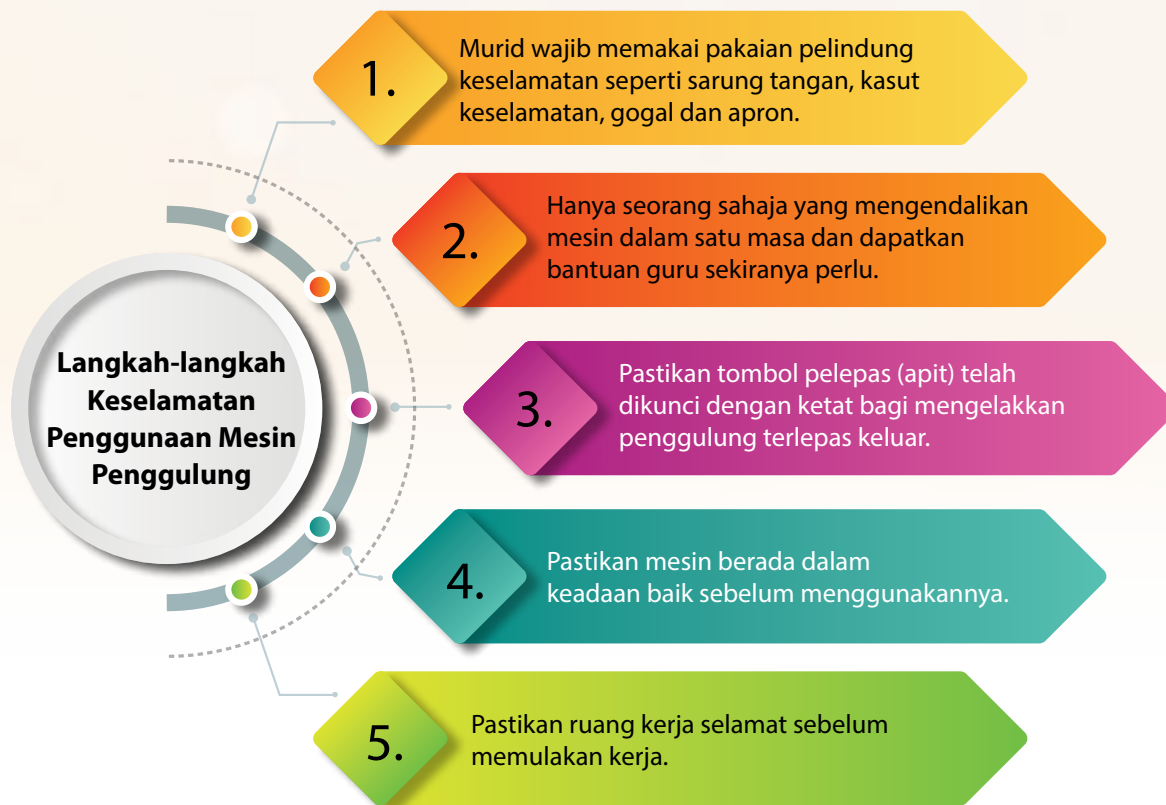
Rajah 2.19 Langkah-langkah keselamatan penggunaan mesin penggulung
