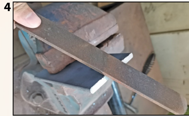
Mengikir gerigis pada plat tersebut menggunakan kikir rata.
