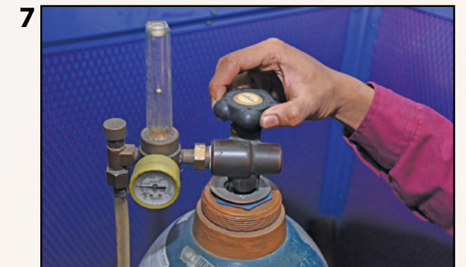
Membuka silinder gas Argon dan melaraskan aliran gas pada 8 hingga 10 liter/ minit.
