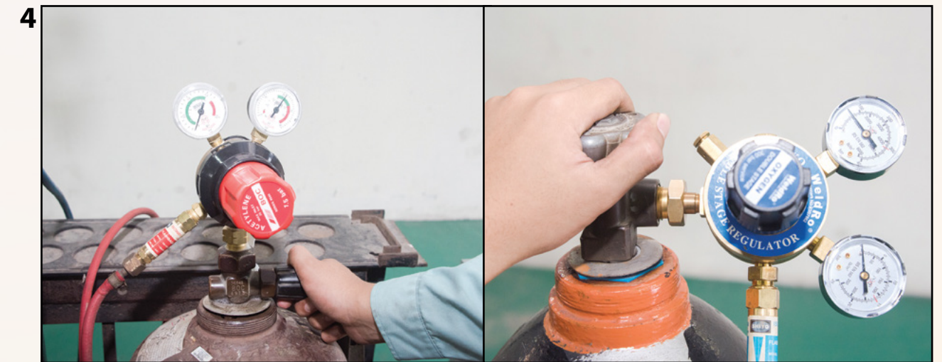
4 Buka injap silinder gas Asetilena dan gas Oksigen.
