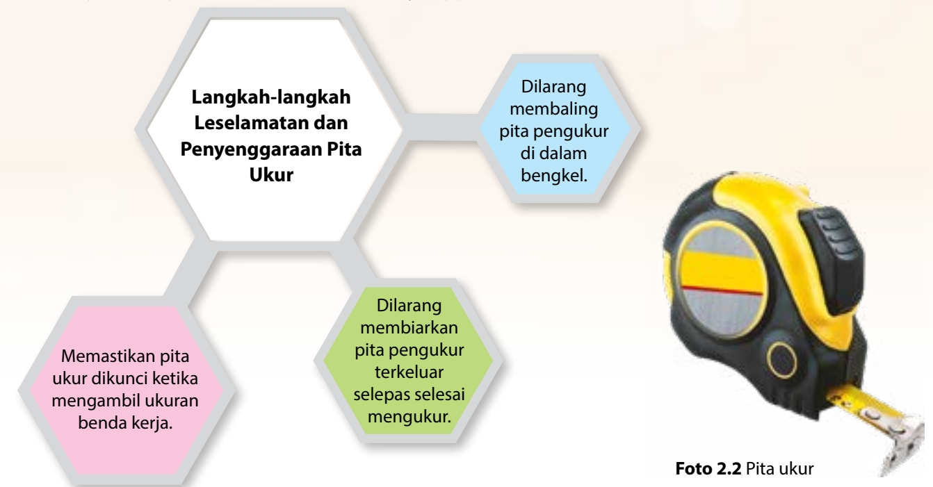
Rajah 2.3 Langkah-langkah keselamatan dan penyenggaraan pita ukur
