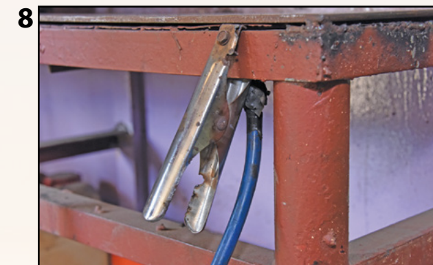
Mengapitkan pengapit bumi pada benda kerja atau meja kerja.
