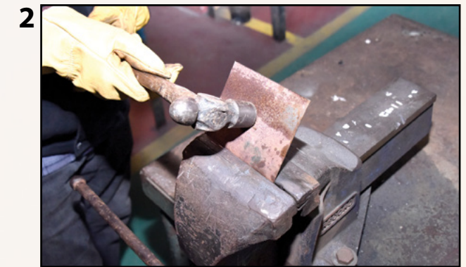
Kepitkan logam tersebut pada ragum meja dan bengkokkan pada garisan yang telah dibuat menggunakan tukul.
