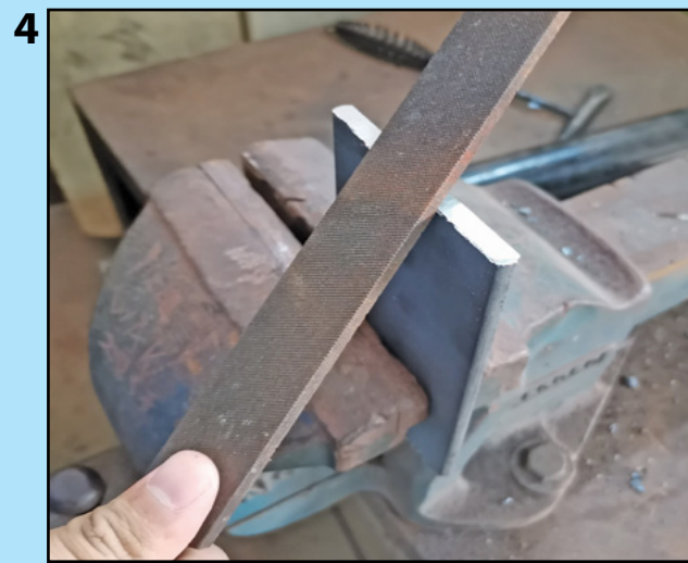
Mengikir gerigis pada plat tersebut menggunakan kikir rata.
