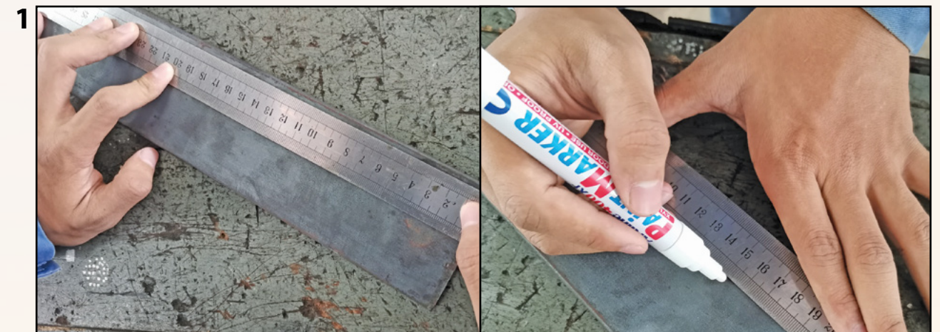
Mengukur plat keluli berkarbon berukuran 3 mm x 50 mm x 150 mm.
