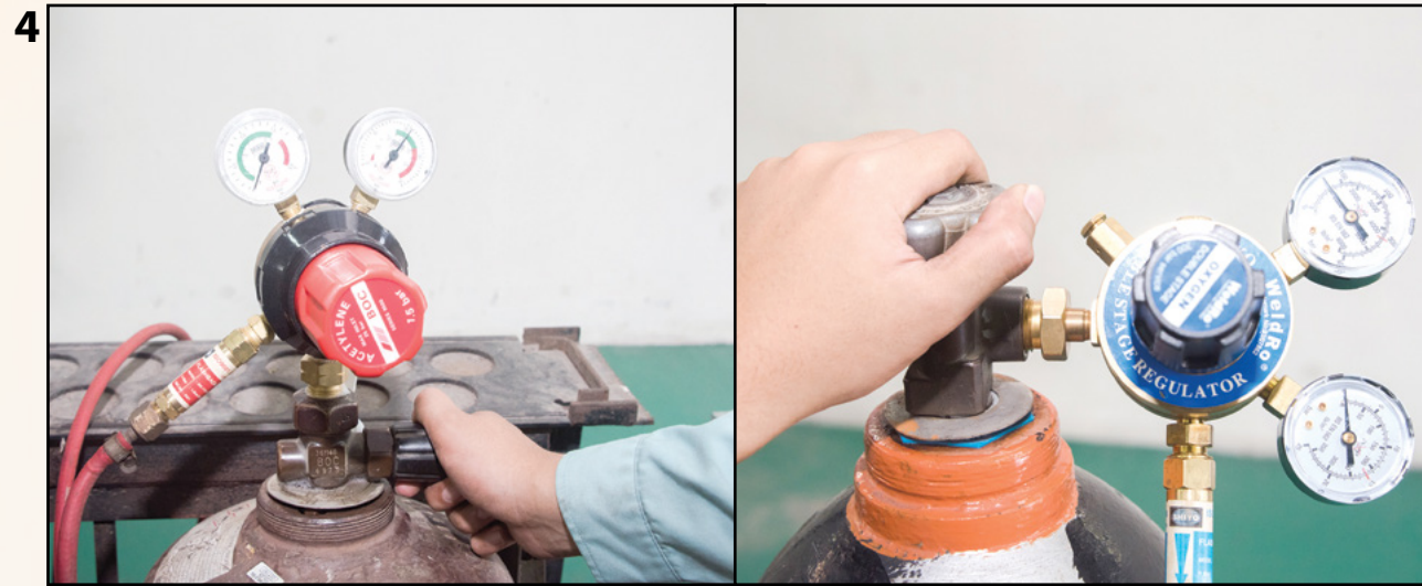
Buka injap silinder gas Asetilena dan gas Oksigen.
