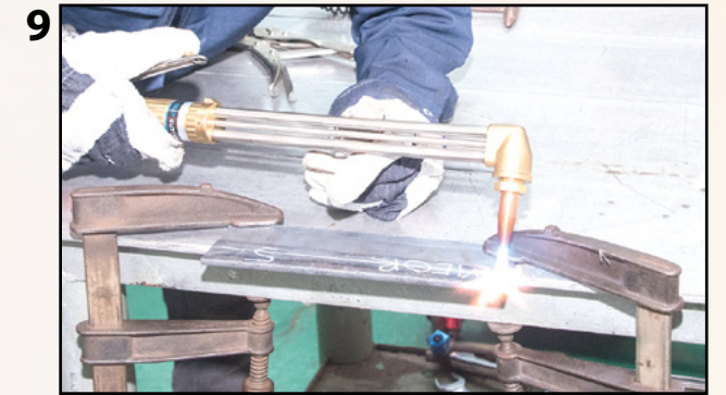
Lakukan proses prapanas pada tepian plat yang telah ditanda sehingga kepingan plat bertukar warna merah ceri.
