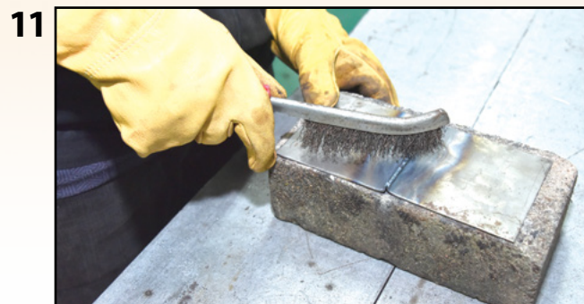
Setelah selesai proses mengimpal, bersihkan benda kerja dengan berus dawai.
