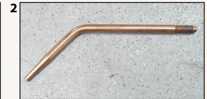
Pilih saiz muncung sumpitan yang sesuai untuk mengimpal logam berketebalan 1.5 mm (saiz No. 2).
