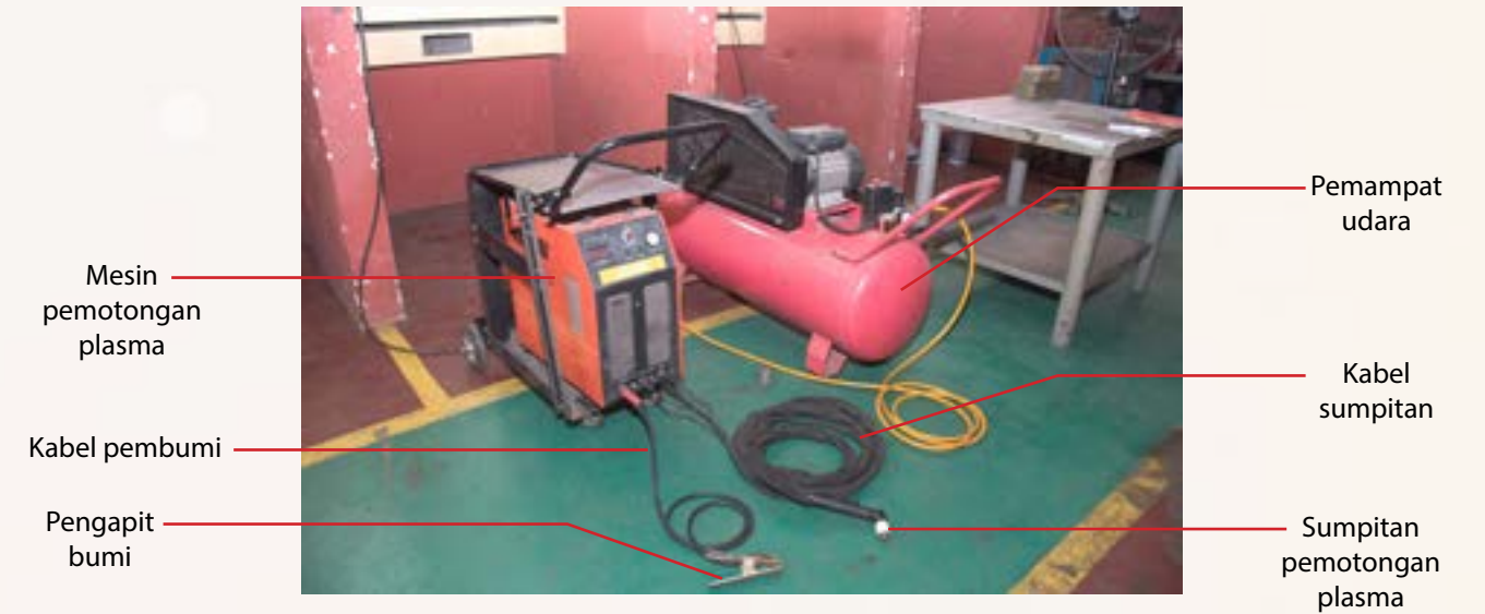
Rajah 4.7 Bahagian-bahagian kelengkapan mesin pemotongan plasma
