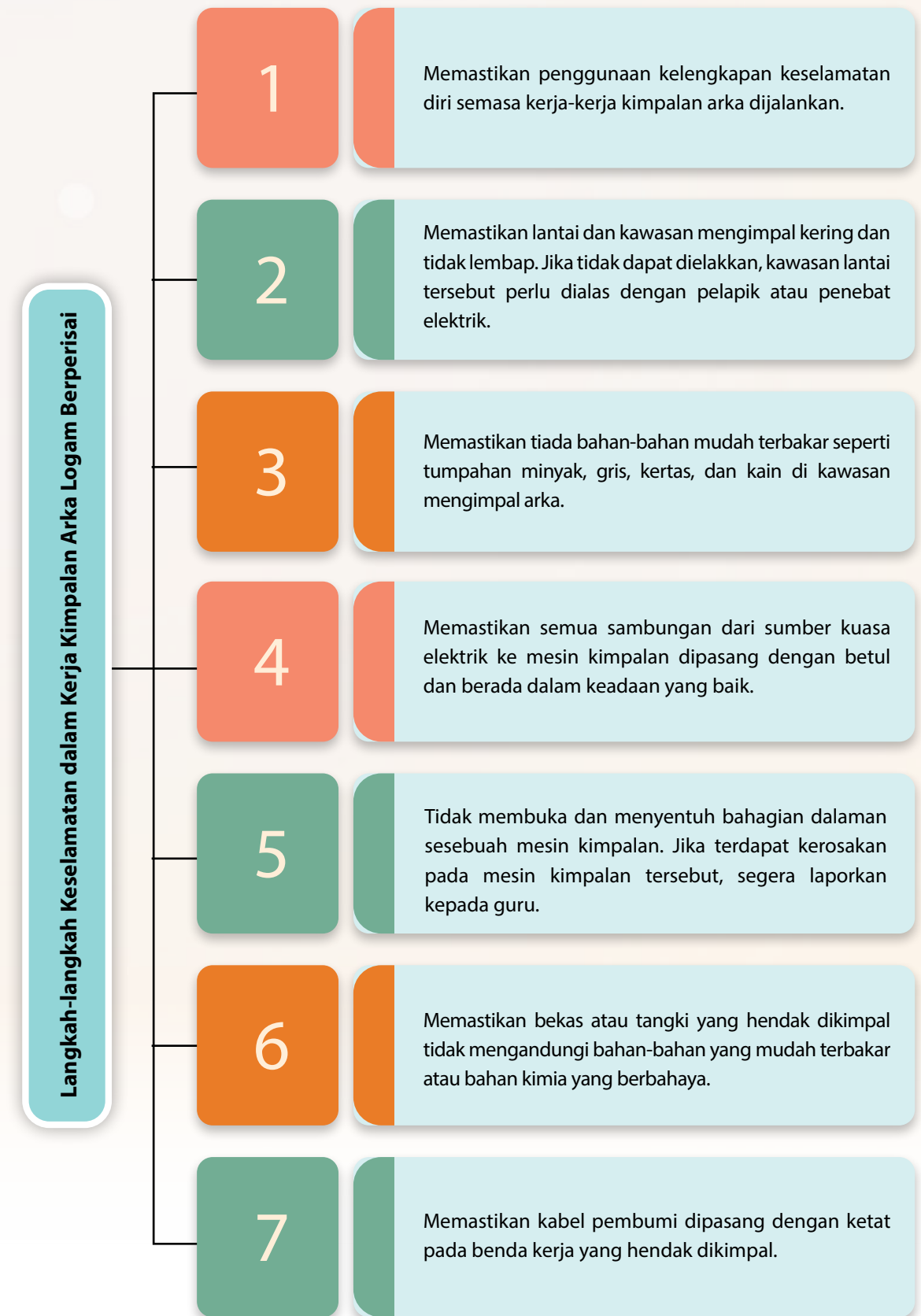
Rajah 3.1 Langkah-langkah keselamatan dalam kerja kimpalan arka logam berperisai
