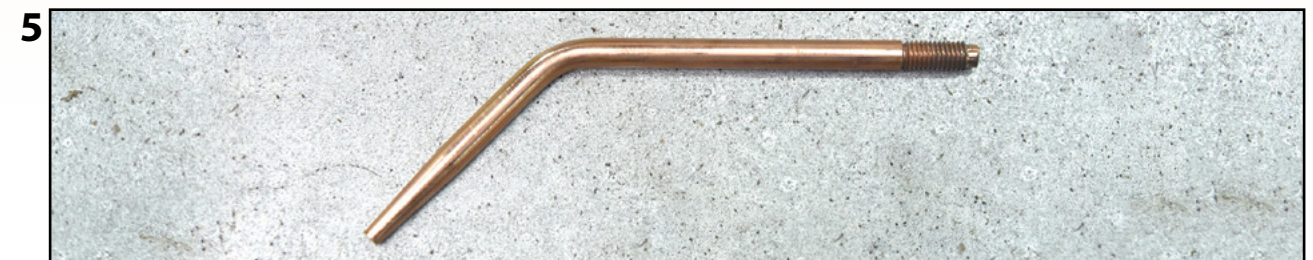
Pilih saiz muncung sumpitan yang sesuai untuk mengimpal logam berketebalan 1.5 mm (saiz No. 2).
