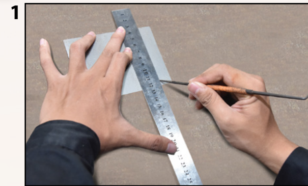
Ukur dan tanda pada plat 5 mm dari hujung logam.
