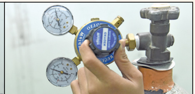
Laraskan tekanan gas Asetilena dan gas Oksigen antara dua hingga tiga psi pada alatur.
