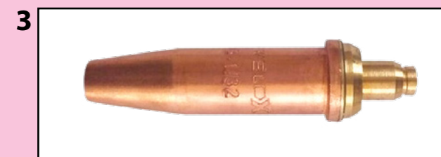
Pilih muncung sumpitan yang sesuai dengan ketebalan kepingan logam 6 mm (saiz 0.8 mm).
