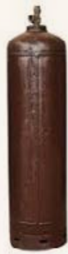
Foto 5.5 Silinder gas Asetilena
