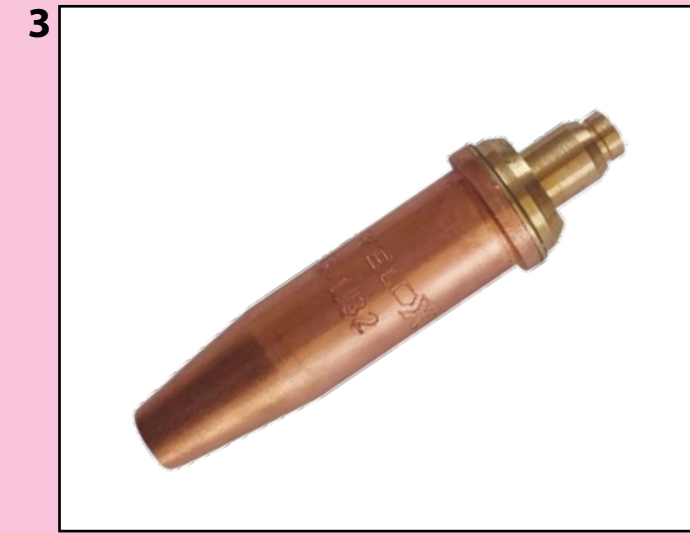
3 Pilih muncung sumpitan yang sesuai dengan ketebalan kepingan logam 6 mm (saiz 0.8 mm).
