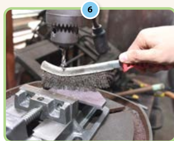
6 Bersihkan tempat kerja setelah selesai kerja menggerudi.
