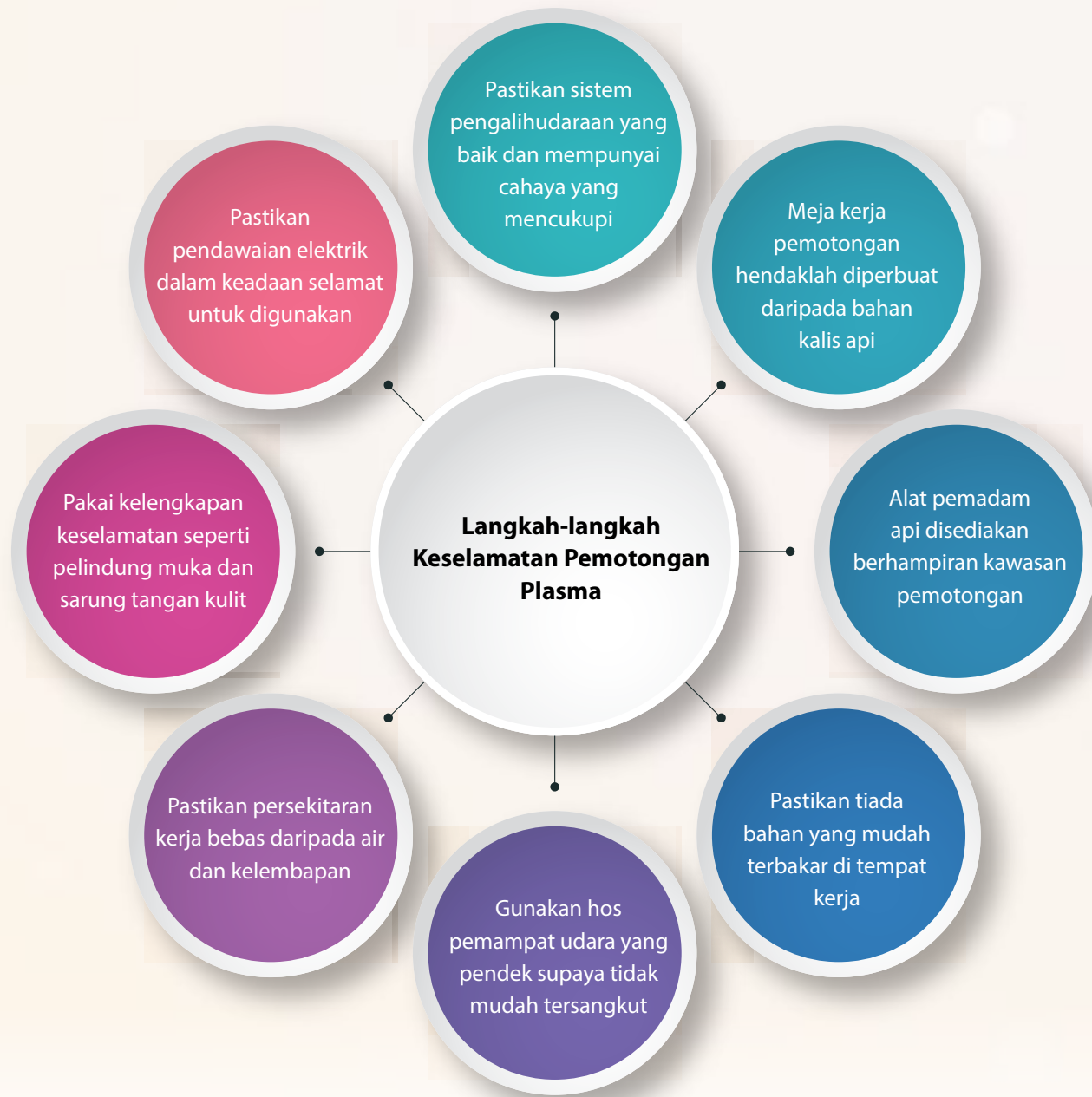
Rajah 4.2 Langkah-langkah keselamatan dalam pemotongan plasma
