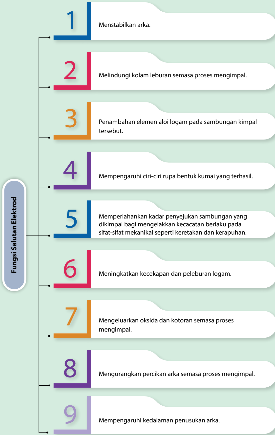
Rajah 3.6 Fungsi salutan elektrod
