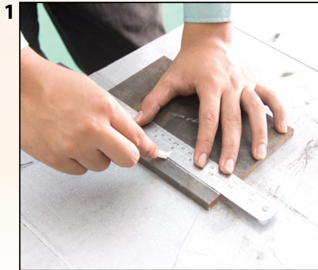
1 Tandakan garisan panduan pemotongan menggunakan kapur kejuruteraan mengikut ukuran yang telah ditetapkan.
