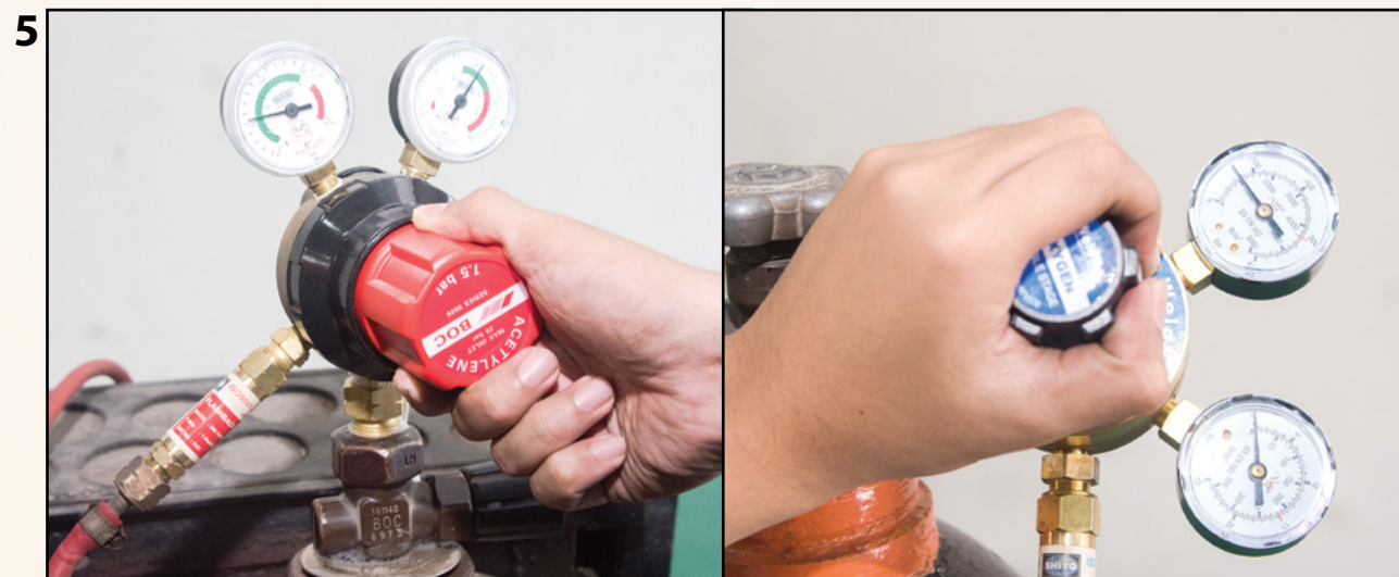
Laraskan pada tekanan yang sesuai iaitu 26 psi bagi gas Oksigen dan 6 psi bagi gas Asetilena.
