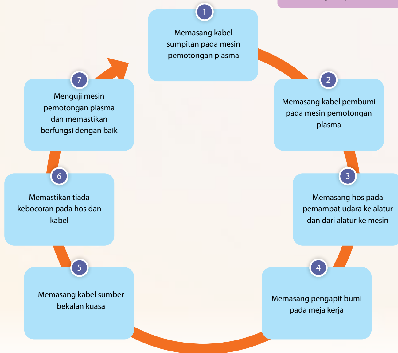
Rajah 4.9 Langkah-langkah kerja pemasangan kelengkapan pemotongan plasma
