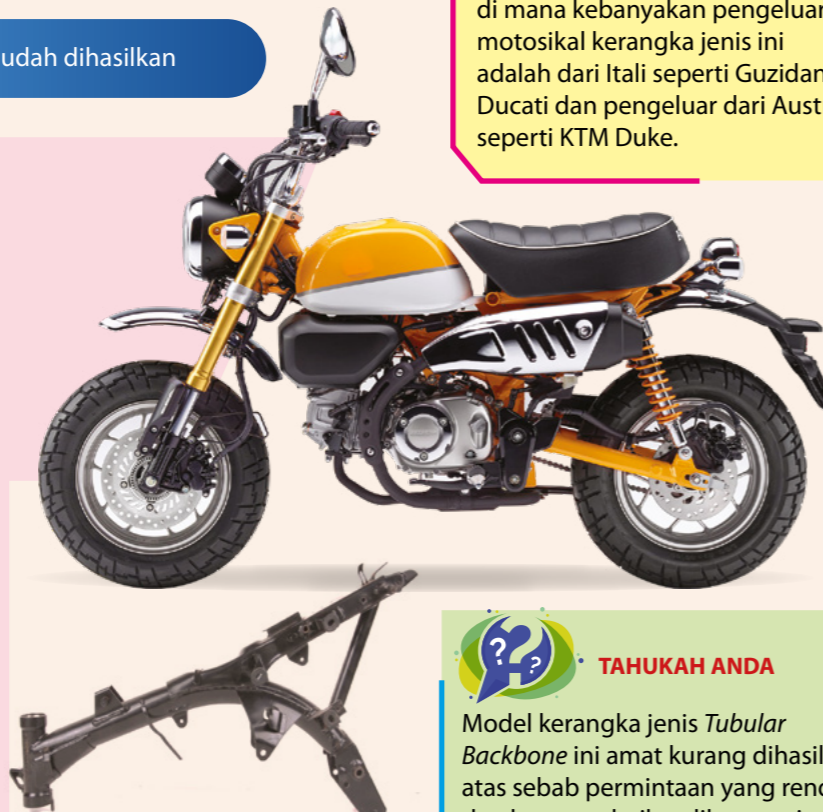
Foto 3.5 Contoh motosikal dan kerangka Tubular Backbone Frame
