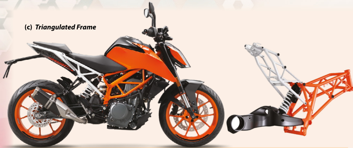
Foto 3.4 Contoh motosikal dan kerangka Triangulated Frame
