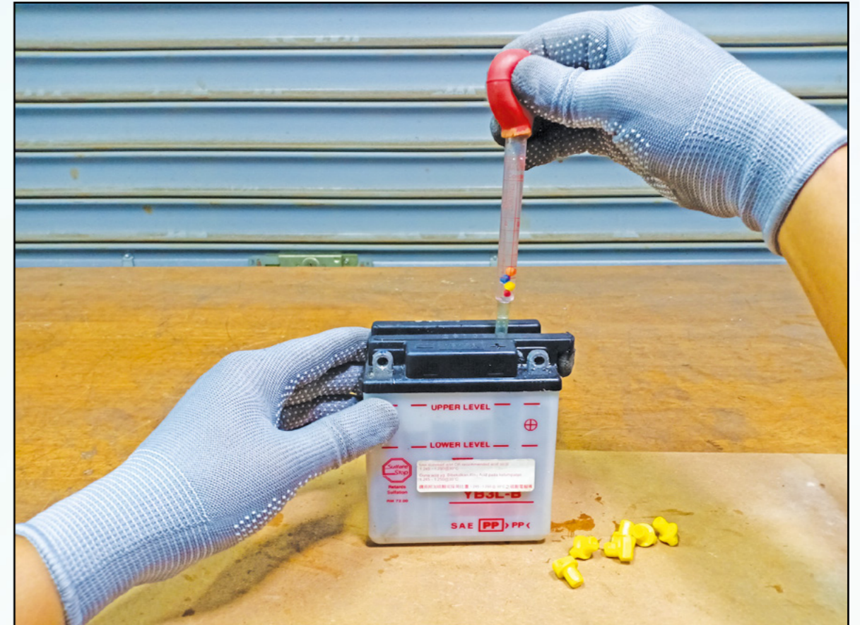
Foto 7.1 Menguji ketumpatan elektrolit dan voltan bateri
