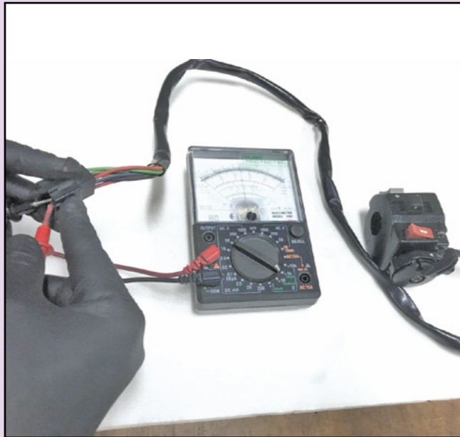
Periksa suis lampu isyarat dengan menggunakan meter pelbagai.
