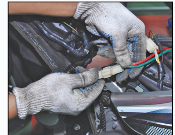
9 Sambungkan semula wayar soket motor penghidup.
