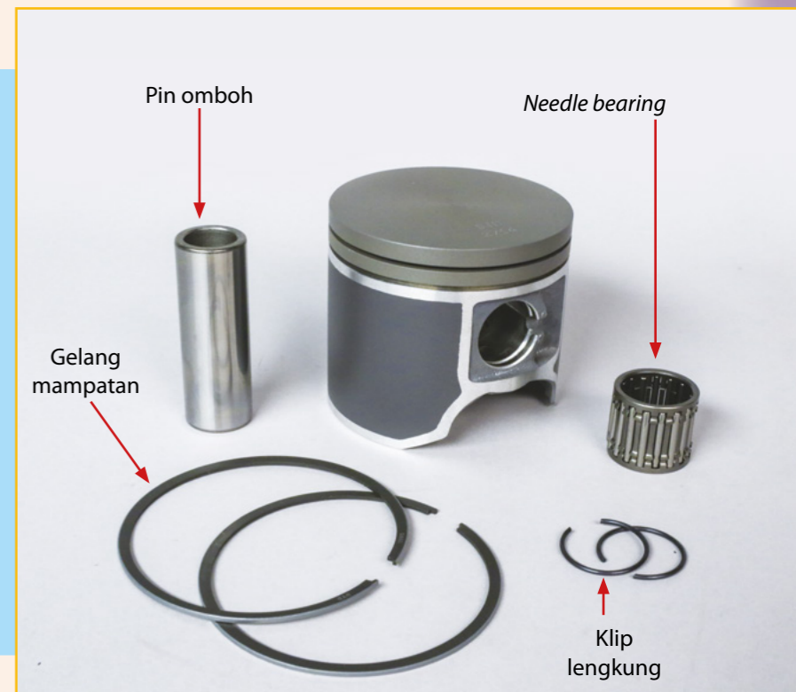
Foto 2.31 Komponen pemasangan omboh enjin dua lejang
