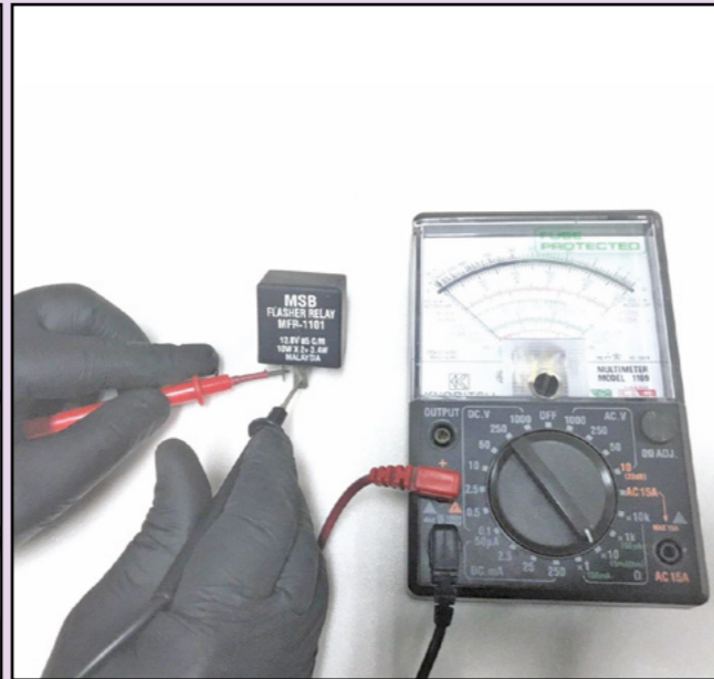
Periksa unit pengelip dengan menggunakan meter pelbagai ataupun test lamp.
