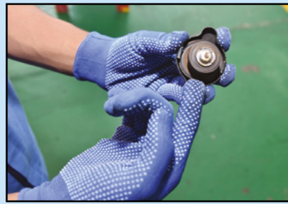
Periksa keadaan getah pengadang. Jika kelihatan retak, tukar penutup radiator.
