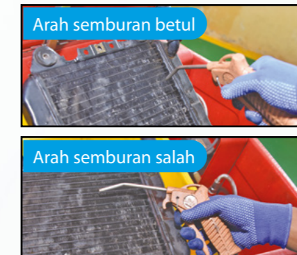
Gunakan semburan udara pada kedudukan menegak dan jarak yang sesuai.
