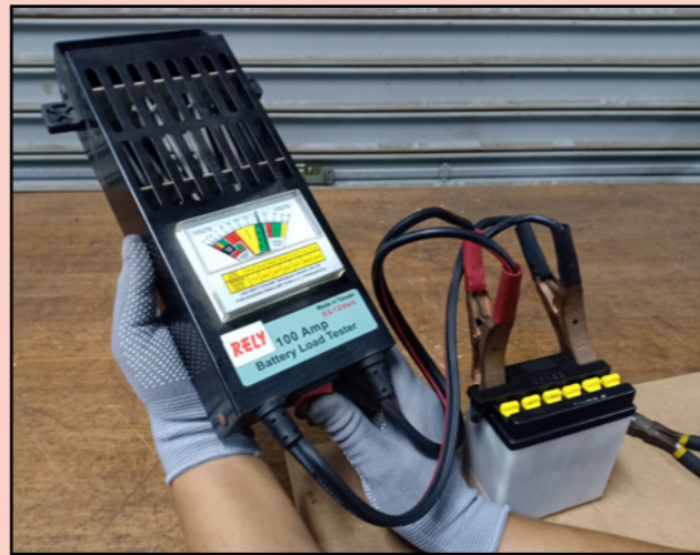
Menguji voltan bateri menggunakan bateri load tester.
