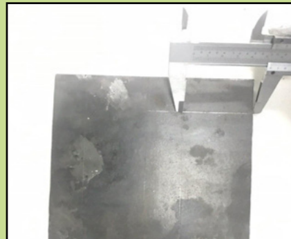
Buat segi empat tepat pada ukuran AF dan DC berdasarkan lukisan teknikal.
