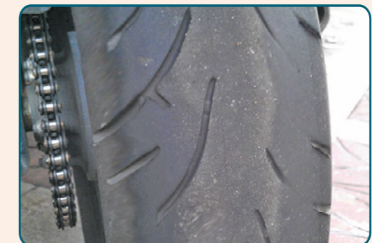
Kehausan pada bahagian bahu tayar. Punca: Tekanan udara tidak mencukupi dan muatan berlebihan.
