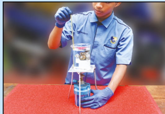
Panaskan air di dalam bikar sehingga mendidih. Pastikan laras suhu tidak mencecah bahagian bawah bikar. Perhatikan suhu termometer dan kedudukan injap laras suhu.
