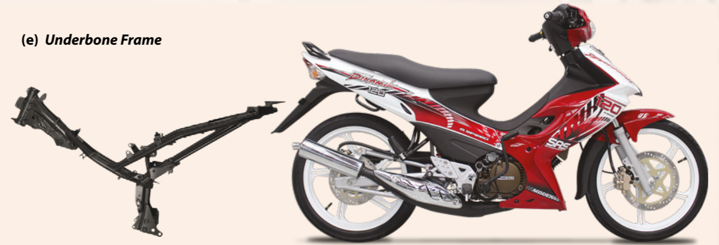
Foto 3.6 Contoh motosikal dan kerangka Underbone Frame
