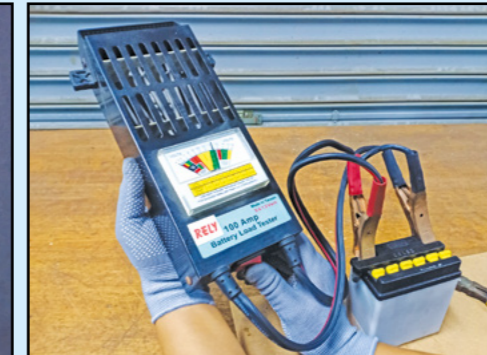
Sambungkan wayar alat pengujian pada terminal bateri dengan betul.
