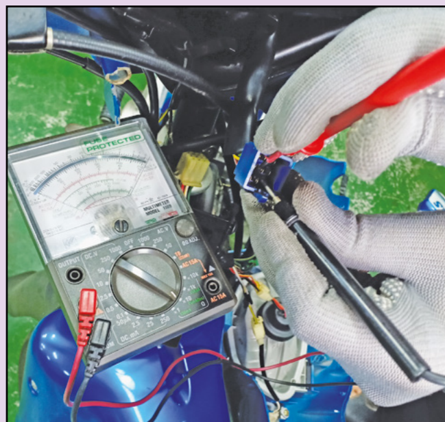
gunakan meter pelbagai untuk memeriksa keterusan pada setiap lampu penunjuk.
