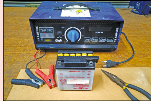
Letakkan bateri di atas bahan penebat seperti pelapik getah atau papan.
