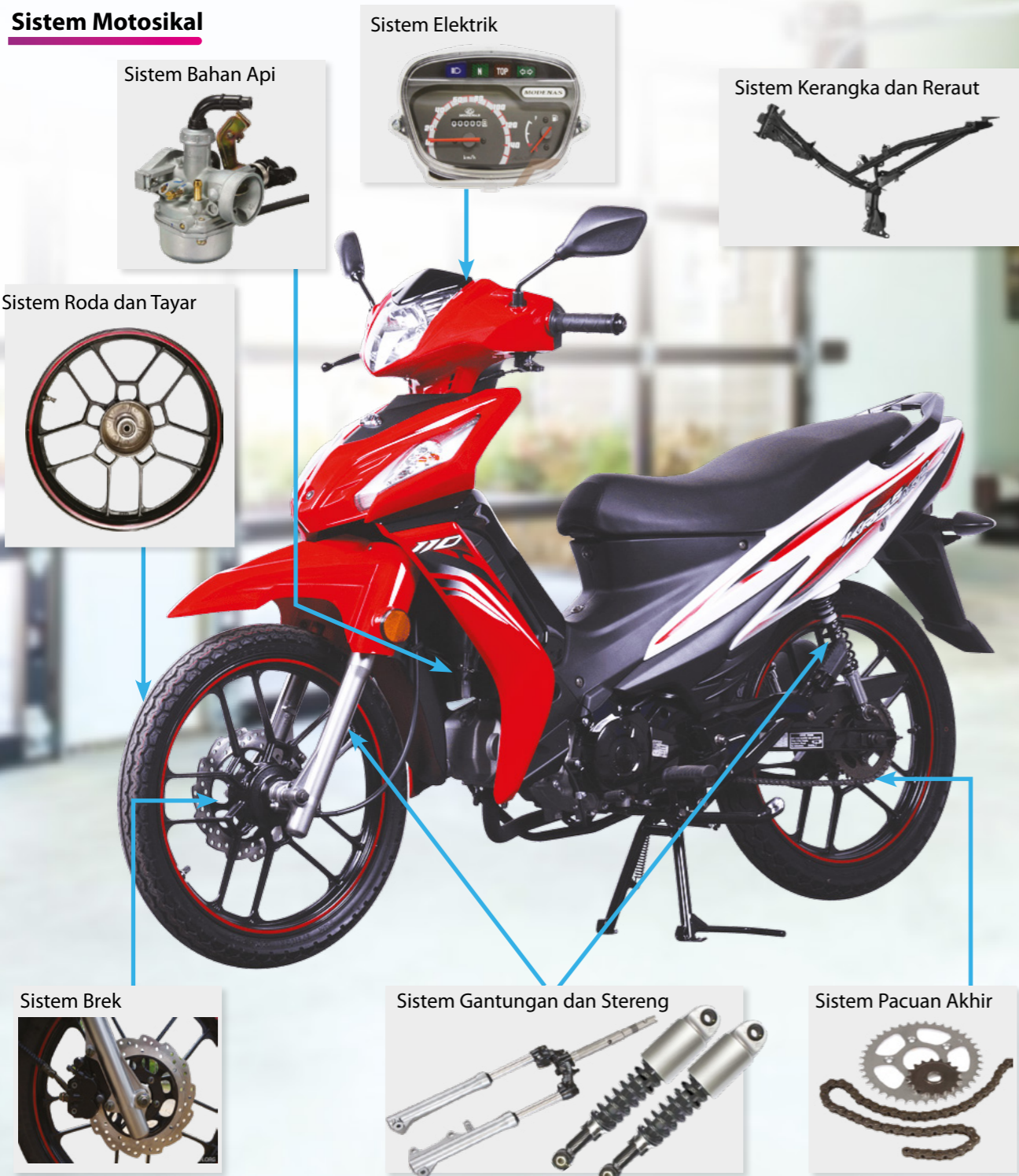
Foto 2.1(a) Sistem yang terdapat pada motosikal
