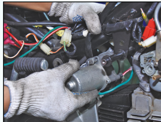
4 Tanggalkan motor penghidup daripada motosikal.
