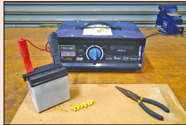
Sambungkan kabel pengecas pada bateri.
