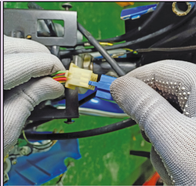
Tanggalkan wayar atau soket yang bersambung dengan meter penunjuk.
