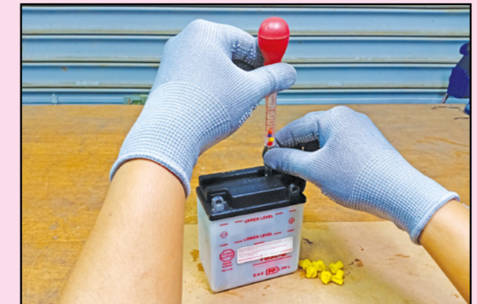
Masukkan alat hidrometer ke dalam liang bateri dengan betul.
