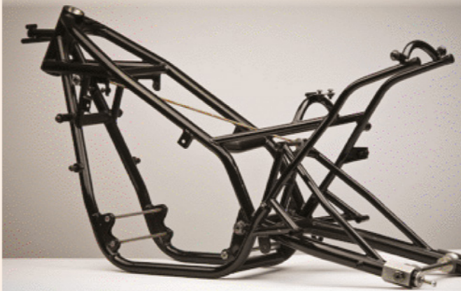
Foto 3.3 Contoh motosikal dan kerangka Duplex Cradle Frame
