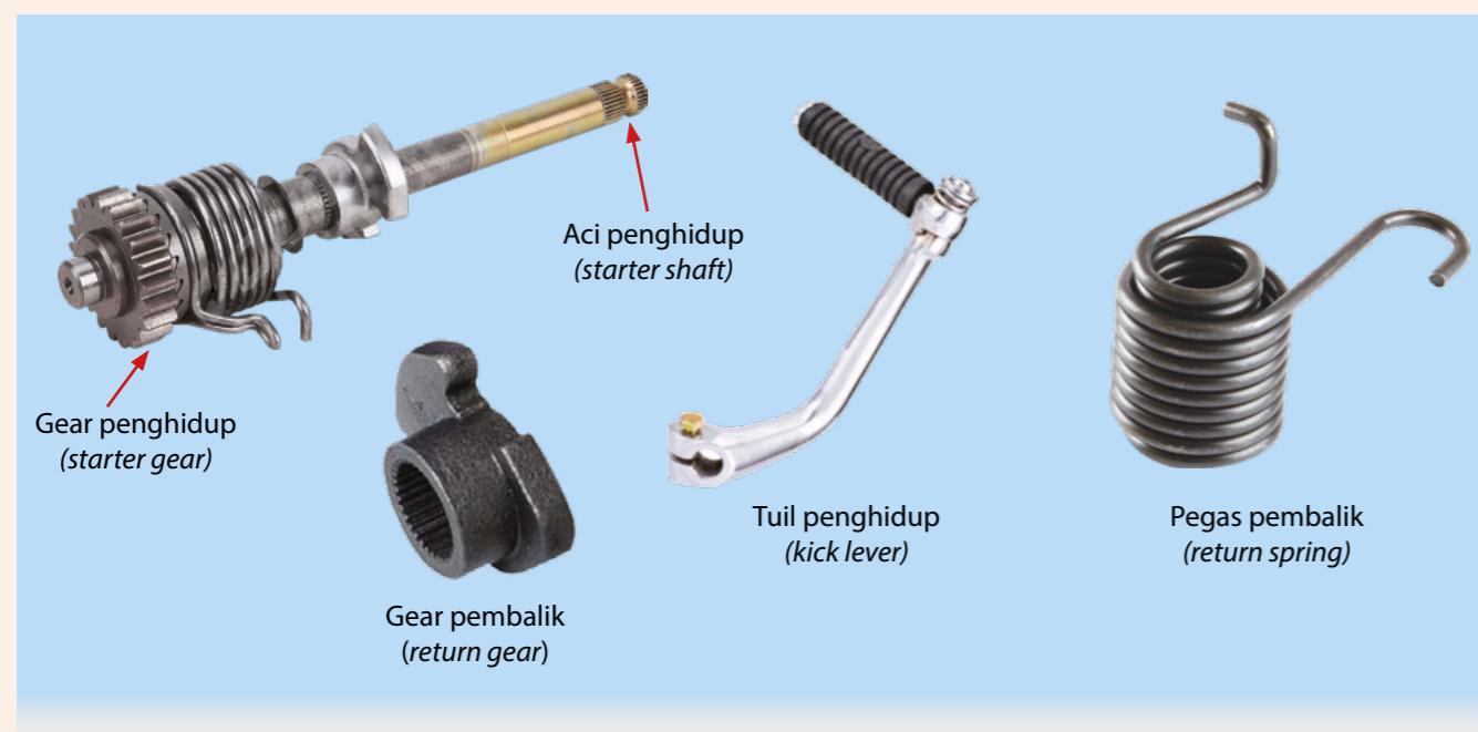
Foto 2.23 Komponen sistem penghidup tendang
