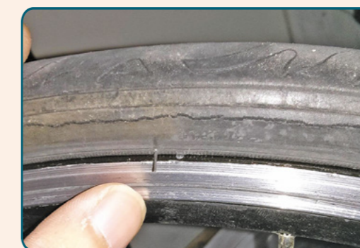
Kerosakan pada bahagian dinding sisi tayar. Punca: Galas roda longgar atau haus dan masalah pada sistem gantungan.
