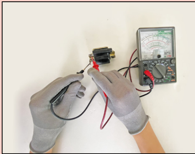
Pengujian keterusan dengan menggunakan meter pelbagai.
