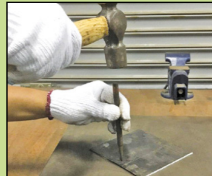
Tanda titik pusat pada garisan yang bersilang.
