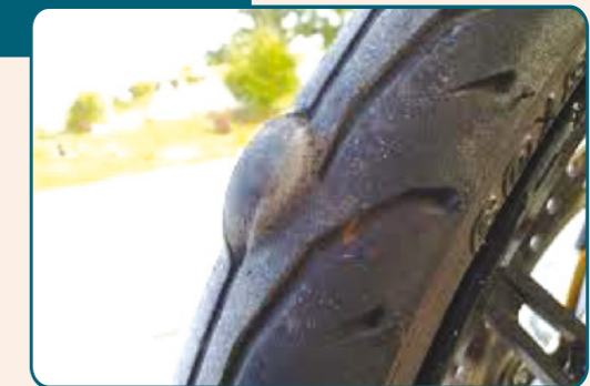
Benjolan pada bahagian tengah tayar. Punca: Tayar memasuki lubang yang dalam.
