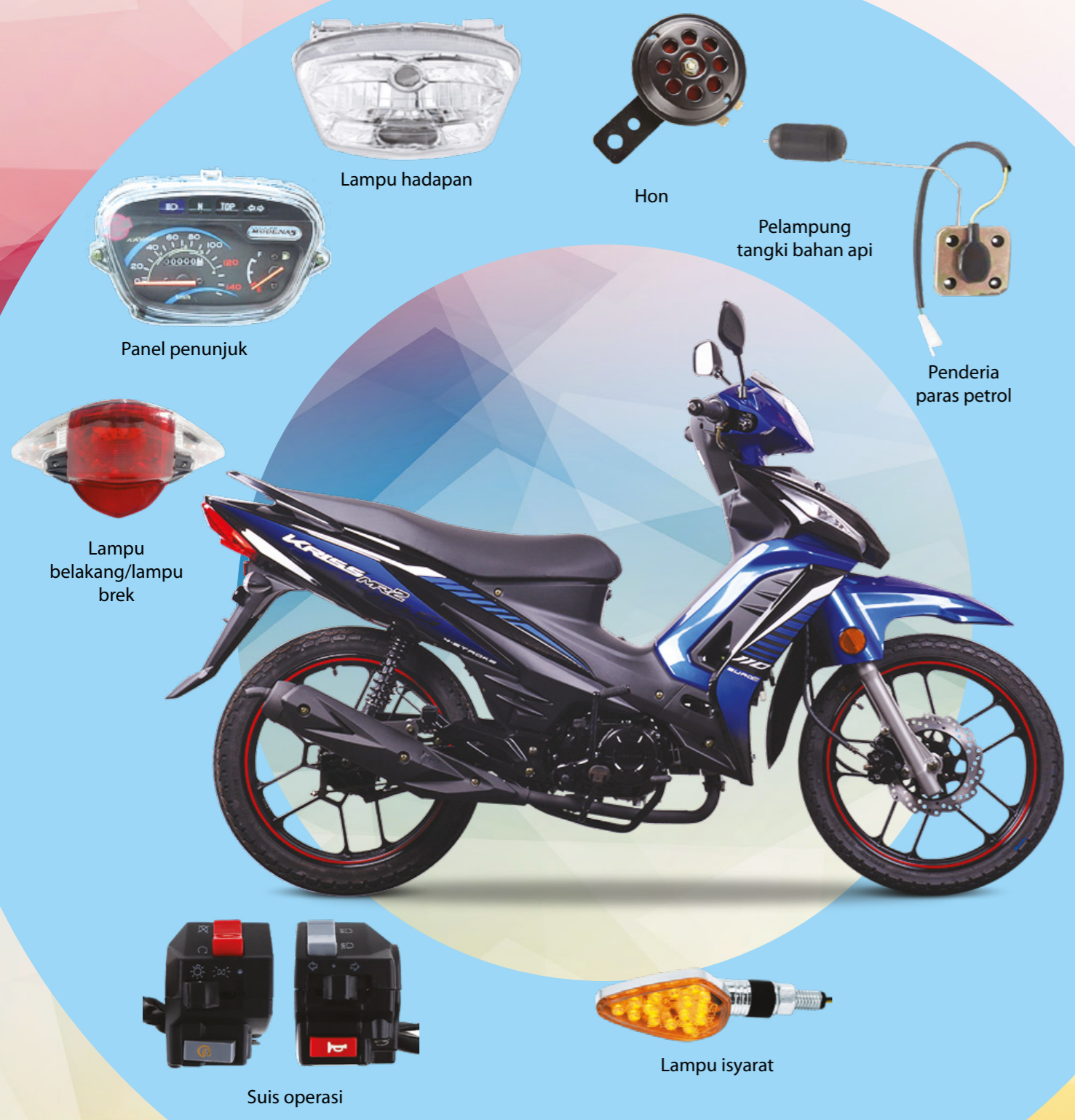
Foto 2.20 Komponen sistem lampu dan penunjuk
