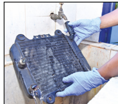
Gunakan air untuk mencuci radiator.
