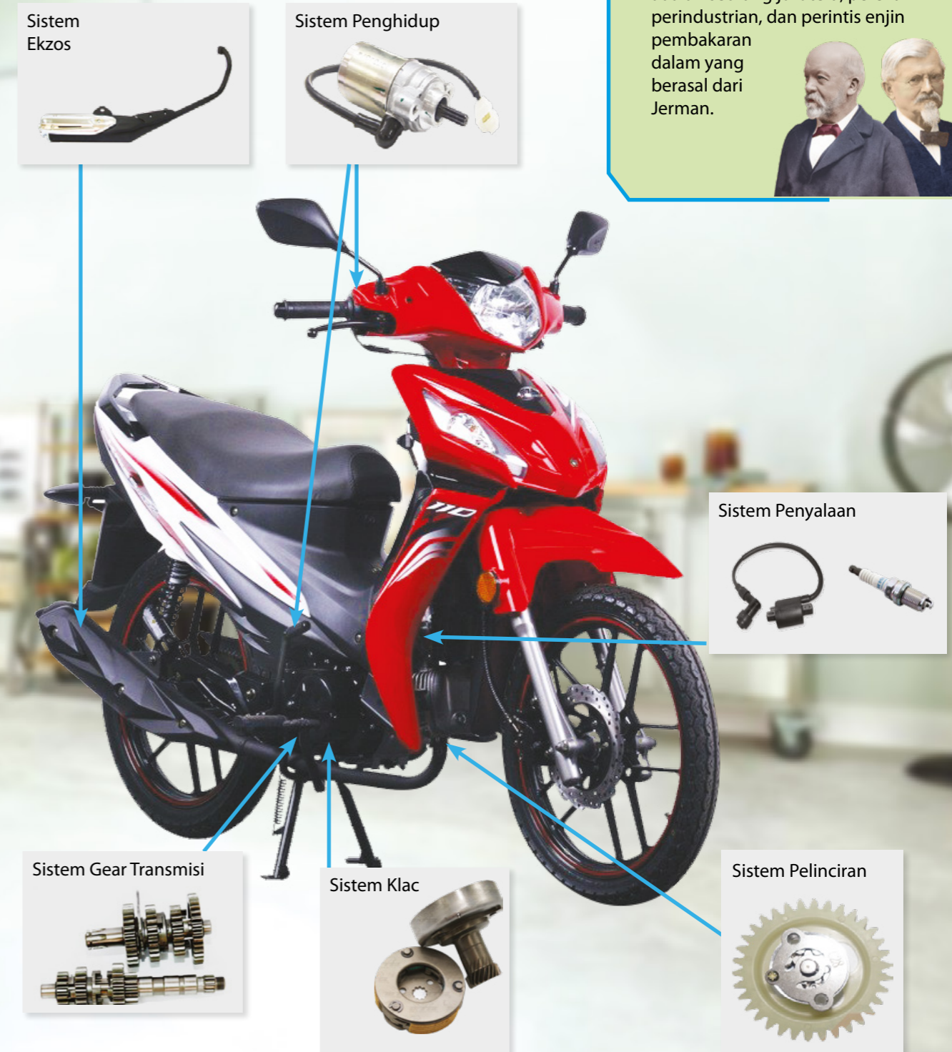
Foto 2.1(b) Sistem yang terdapat pada motosikal
