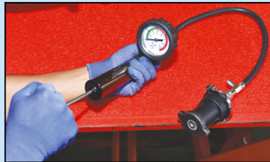
Uji penutup radiator menggunakan penguji tekanan.
