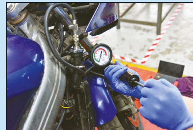
Uji kebocoran sistem penyejukan cecair menggunakan radiator pressure tester . Sekiranya bacaan tekanan menurun, bermakna terdapat kebocoran pada komponen sistem penyejukan.
