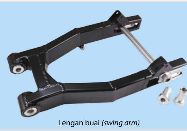
Foto 2.8 Komponen sistem gantungan
