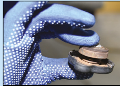
Periksa pegas secara visual. Jika ada kerosakan, tukar penutup radiator.
