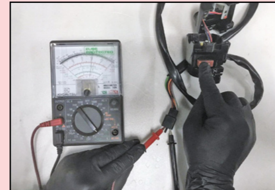
Periksa suis hon dengan menggunakan meter voltan sama ada terdapat arus yang mengalir daripada bateri ataupun tidak.
