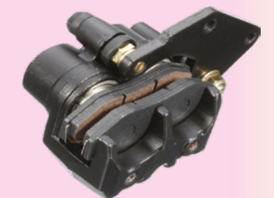
Foto 4.18 Angkup apungan ( floating calliper )
