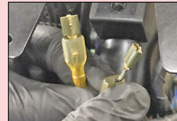
Periksa juga soket yang bersambung dengan hon sama ada terdapat karat ataupun tidak.
