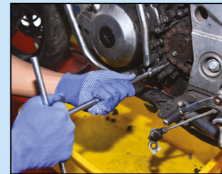
Gantikan gasket pam air, pasang pam air, dan ketatkan bolt mengikut spesifikasi.
