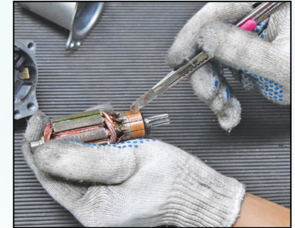
7 Bersihkan permukaan dan celahan komutator.
