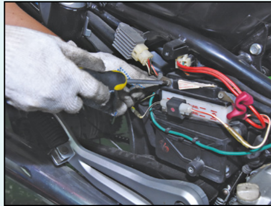
1 Tanggalkan terminal positif dan negatif pada bateri.
