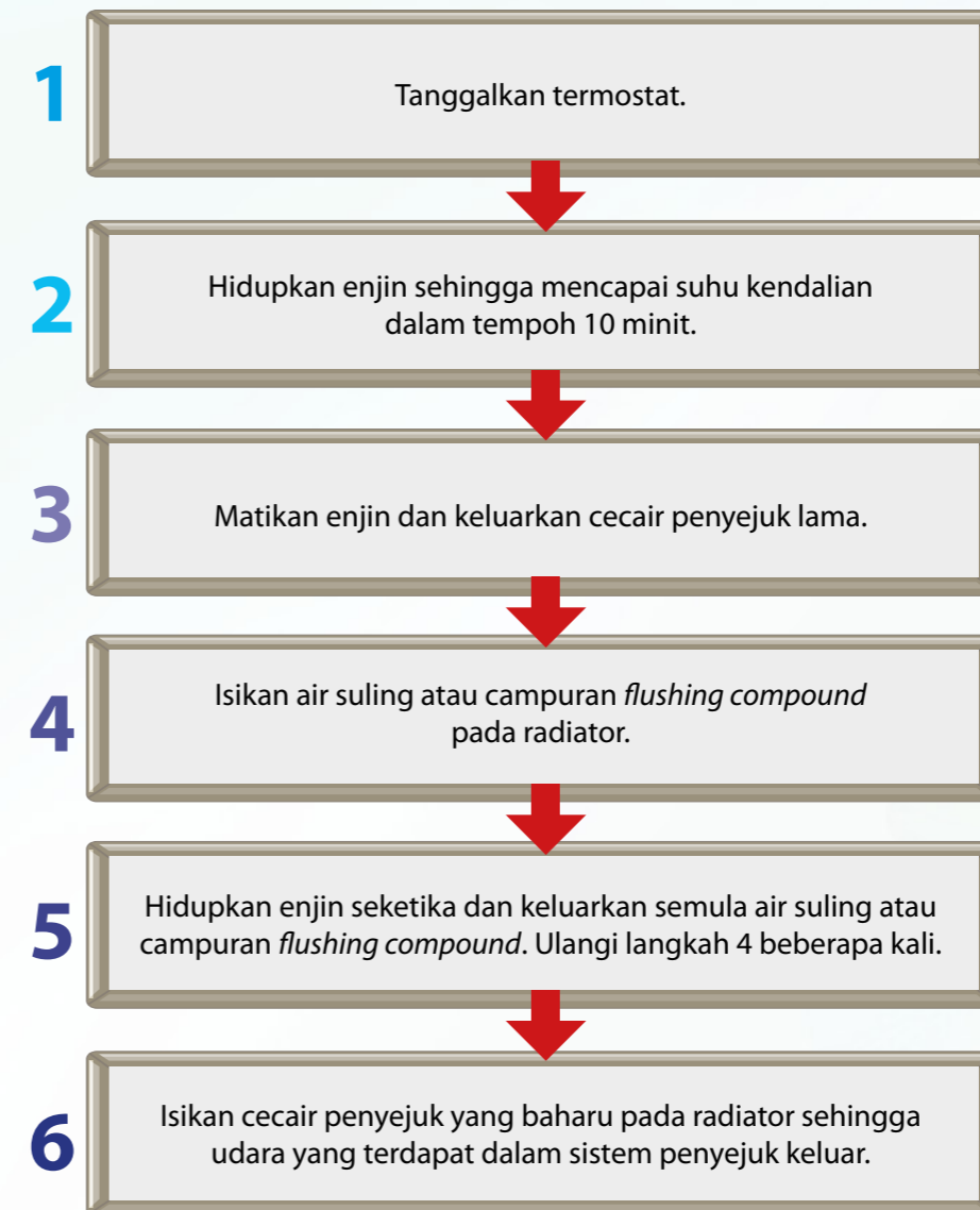
Rajah 6.19 Langkah kerja flushing terus sistem penyejukan cecair motosikal
