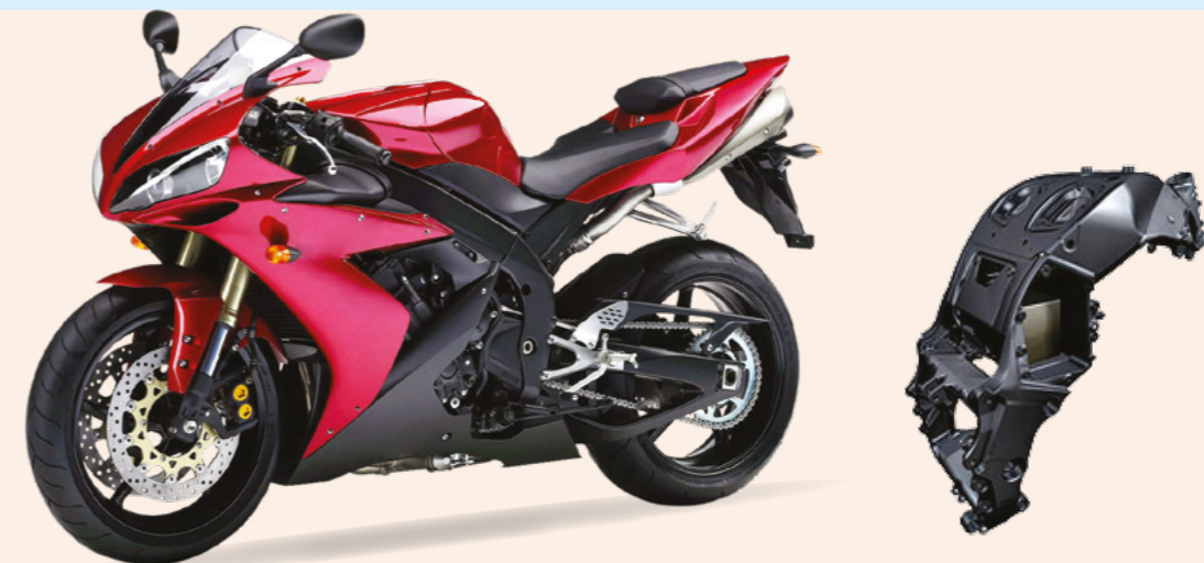
Foto 3.7 Contoh motosikal dan kerangka Delta Box Frame
