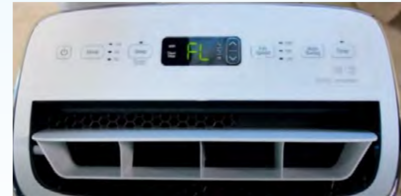
Foto 9.9 Penunjuk di lampu LED yang menunjukkan 'FL'
