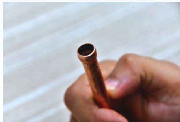
4. Setelah selesai, longgarkan nat dan keluarkan tiub kuprum dari blok swaging .
