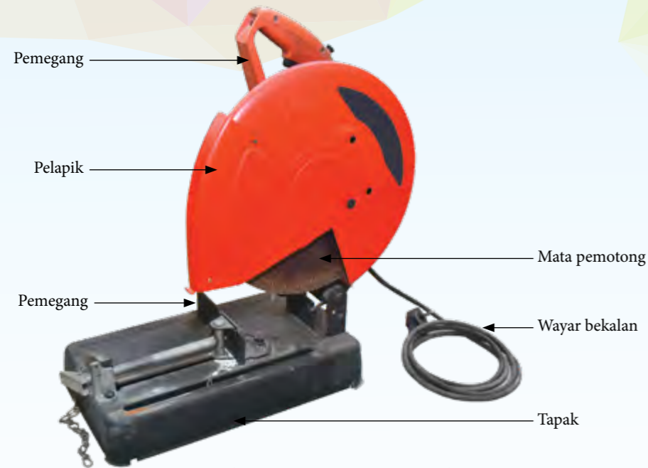
Foto 3.14 Bahagian utama mesin pemotong besi
