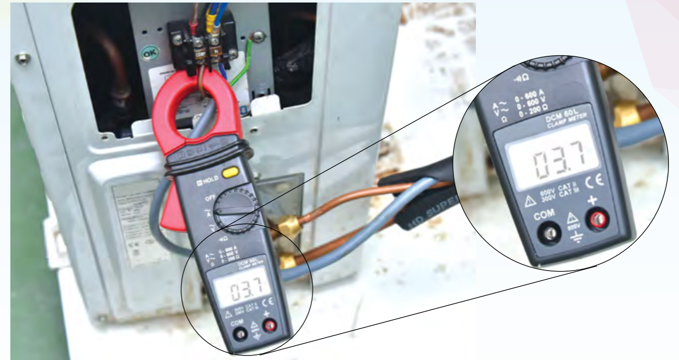
Foto 5.8 Menguji lari pemampat
