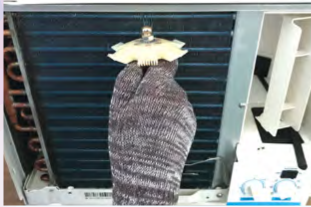
Kerja meluruskan sirip penyejat
