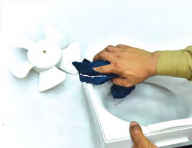
3. Bersihkan kotoran dengan menggunakan pam vakum atau kain bersih.
