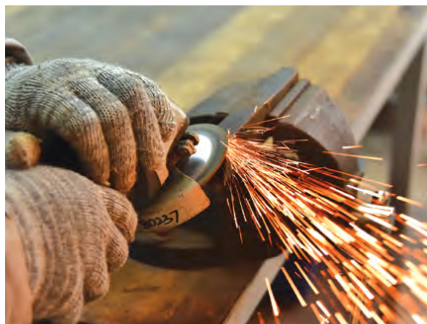
Foto 2.26 Penggunaan mesin canai mudah alih
