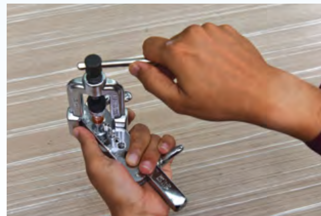
3. Masukkan alat swaging pada blok dan kedudukannya mestilah selari dengan tiub kuprum. Pusingkan tuil mengikut arah jam sehingga ketat.
