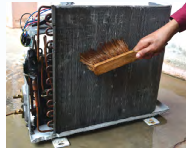
3. Semburkan bahan kimia ke permukaan pemeluwap dan biarkan selama 5 hingga 10 minit. Kemudian, cuci pemeluwap dengan menggunakan air.
