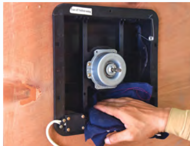
3. Bersihkan kotoran dengan menggunakan pam vakum atau kain bersih.
