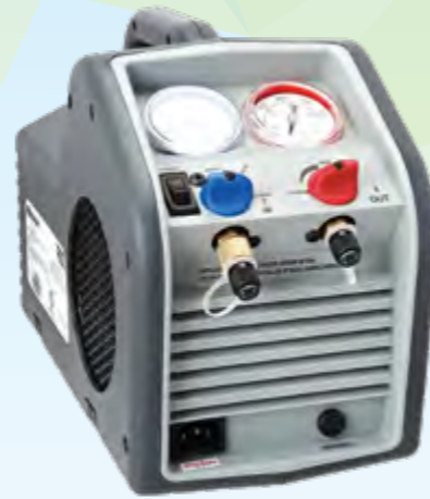
Foto 1.5 Mesin tebus guna
