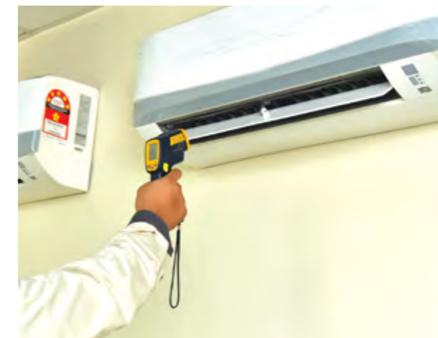
Menguji suhu unit dalam
