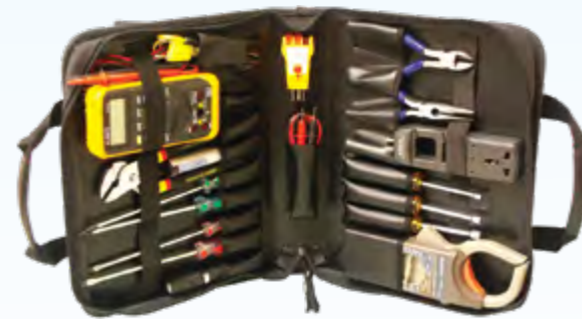
Rajah 9.3 Peralatan menservis unit penyaman udara
