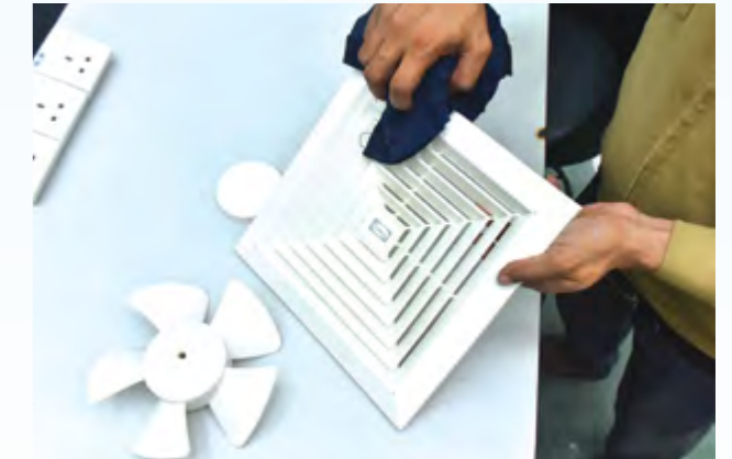
3. Bersihkan kotoran dengan menggunakan pam vakum atau kain bersih.
