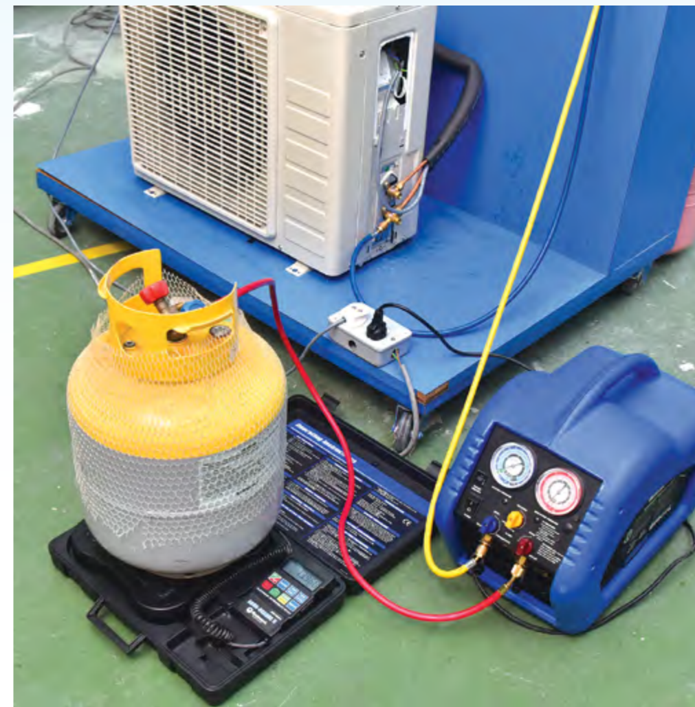
Foto 2.49 Penggunaan mesin tebus guna (Recovery machine)
