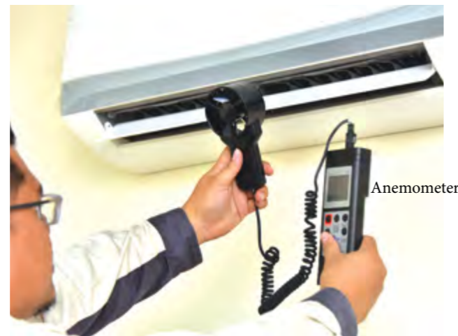
Foto 5.20 Menguji kelajuan udara yang keluar dari penyejat
