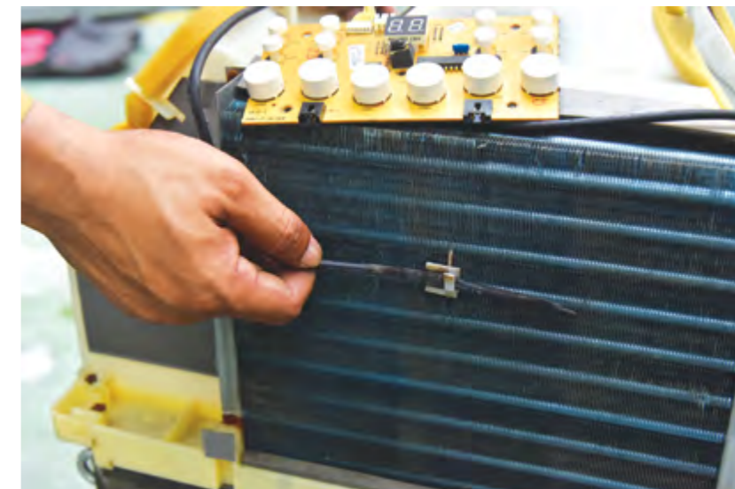
3. Tanggalkan sensor atau komponen elektrik yang perlu diganti.
