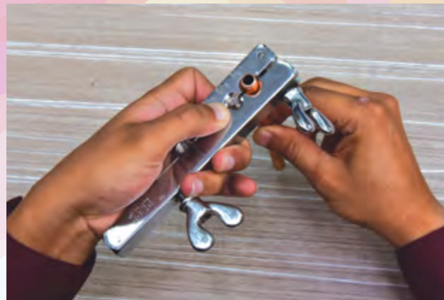
1. Masukkan tiub kuprum ke dalam blok swaging mengikut saiz dan ketinggian yang sesuai.
