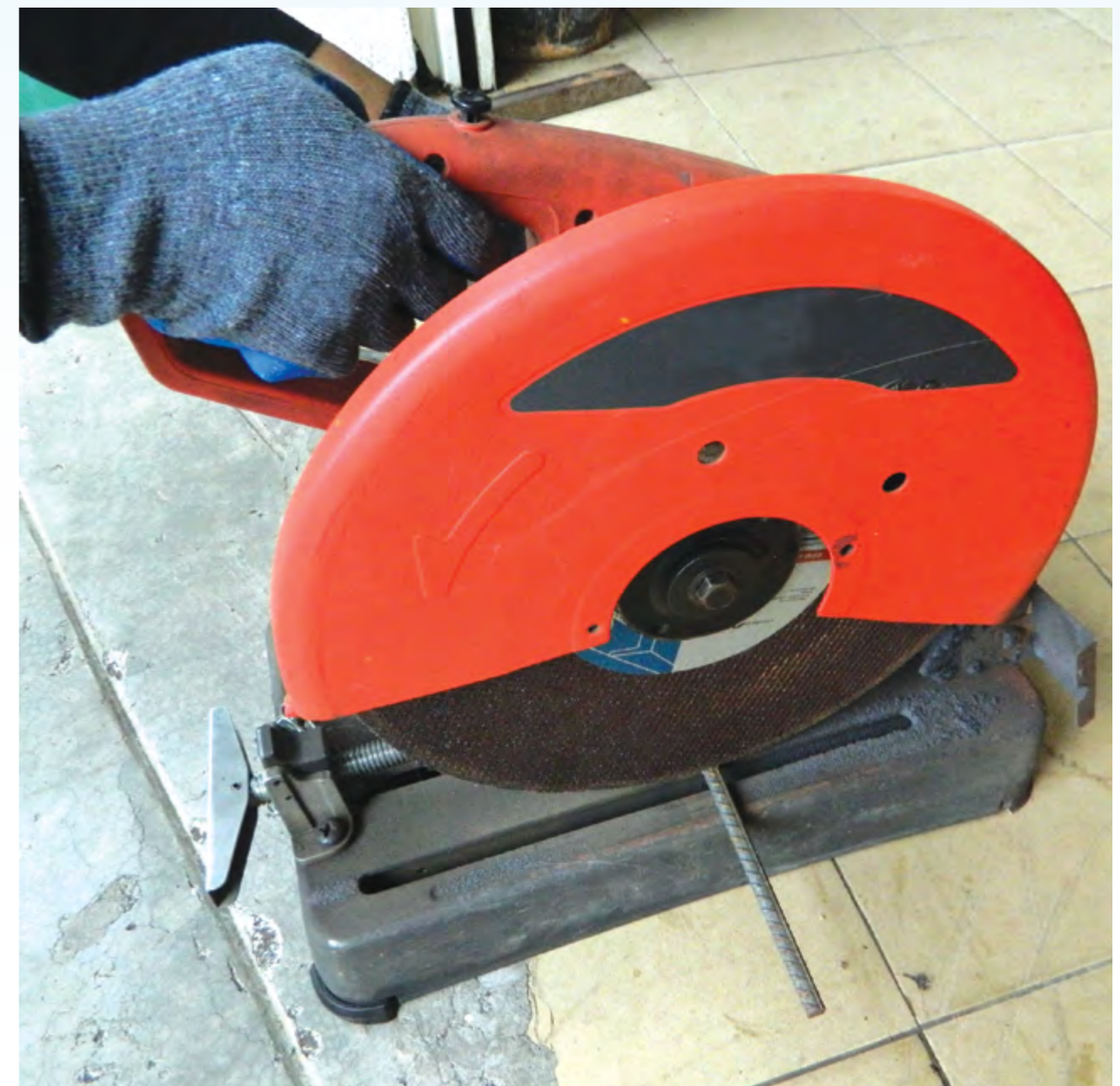
Foto 2.37 Penggunaan mesin pemotong besi mudah alih
