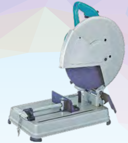
Foto 2.36 Mesin pemotong besi mudah alih
