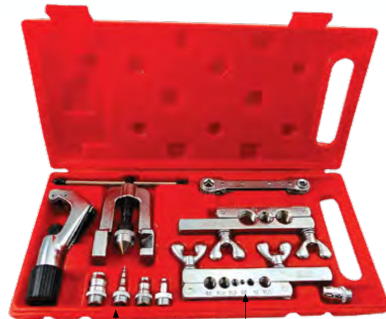
Foto 4.17 Alat swaging tiub kuprum
