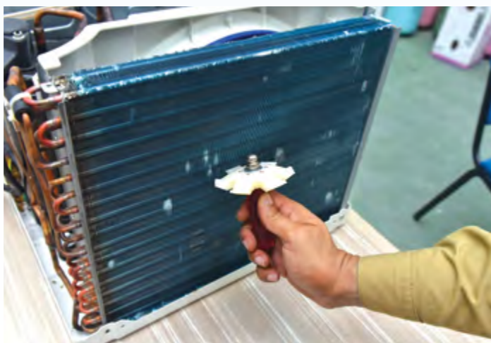
Foto 5.24 Membersihkan pemeluwap dengan menggunakan sikat sirip
