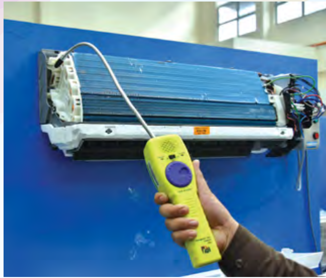
Foto 5.17 Pengesan kebocoran elektrik (leak detector)
