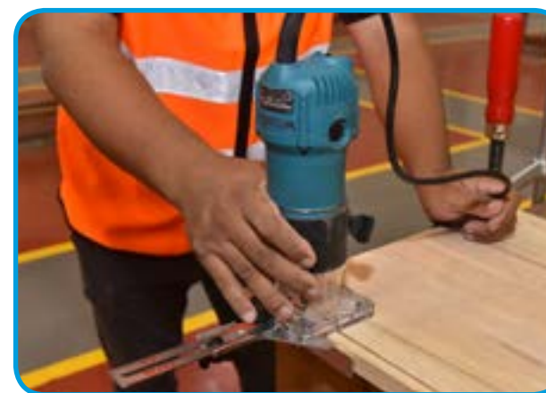
Membentuk sisian atau kumai pada muka laci menggunakan mesin pengumai ( wood trimmer machine ).
