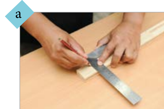
a Membuat rancang tanda puting tanggam pada bahan menggunakan alatan yang betul supaya hasil kerja kemas dan tepat.
