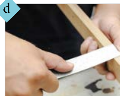
b Mengukur, menanda dan memotong mengikut lukisan produk.
