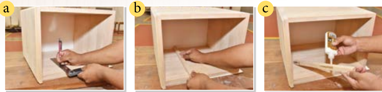
a Rancang tanda gelungsur laci. b Letakkan gelungsur laci pada kedudukan yang betul. c Sapukan glu pada gelungsur laci.
