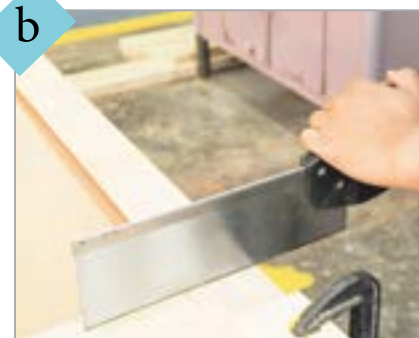
b Mengukur, menanda dan memotong mengikut lukisan produk.
