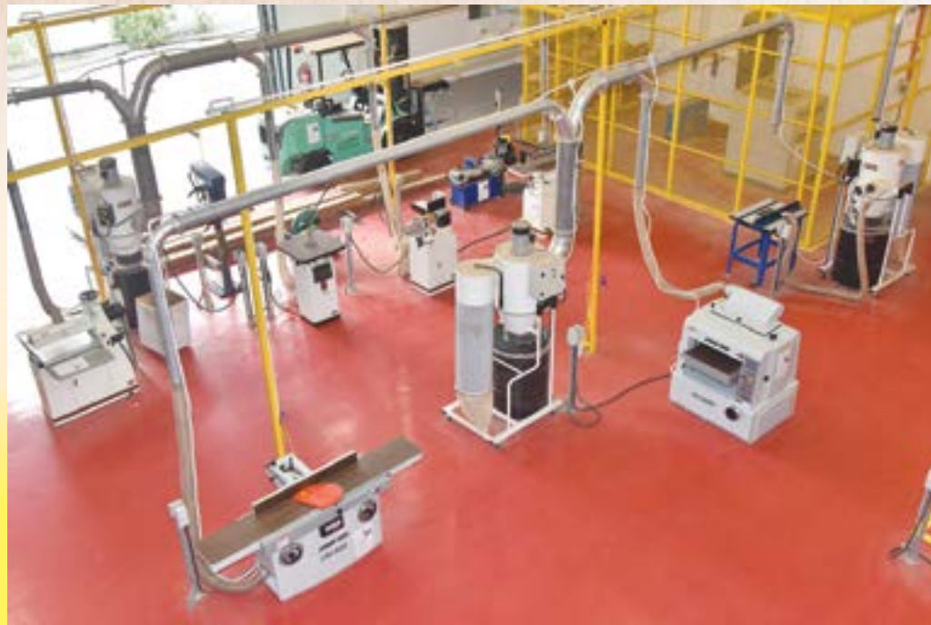
Foto 1.15 Susunan mesin pegun mengikut kesesuaian aliran kerja
