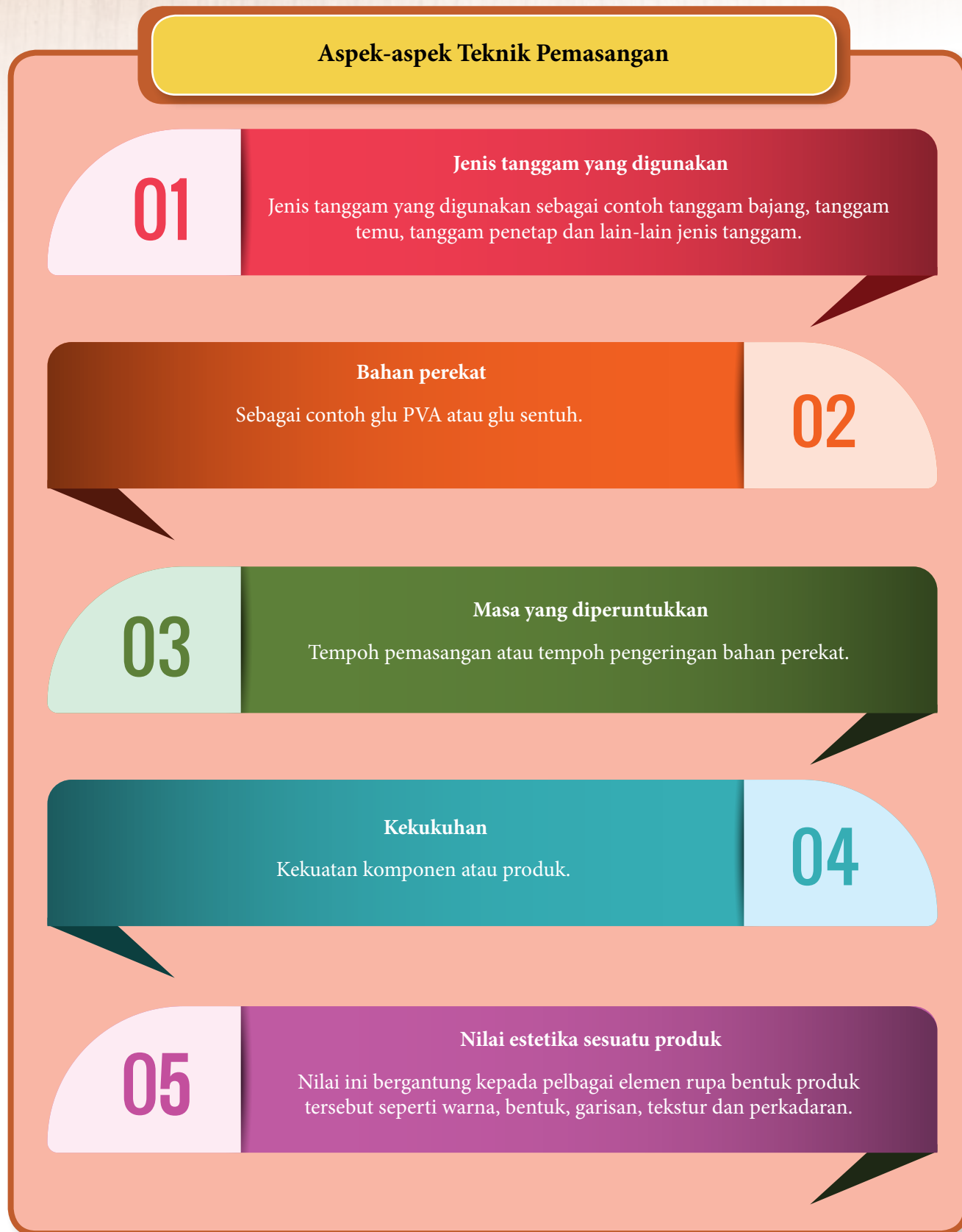
Rajah 5.57 Aspek-aspek teknik pemasangan
