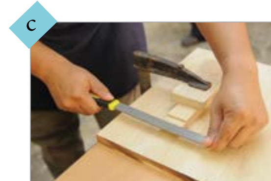
c Mengemaskan puting tanggam menggunakan kikir parut dan kertas las.
