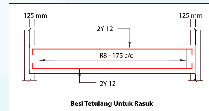
Rajah 4.12 Keratan X-X Substruktur Besi Tetulang Untuk Rasuk
