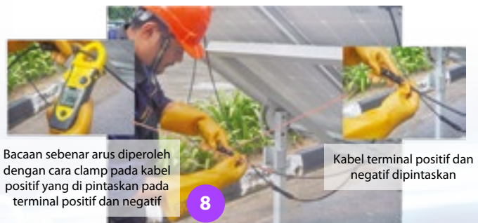
8 Bagi mendapatkan bacaan sebenar arus dalam sambungan siri terminal positif dan negatif perlu dipintaskan.
