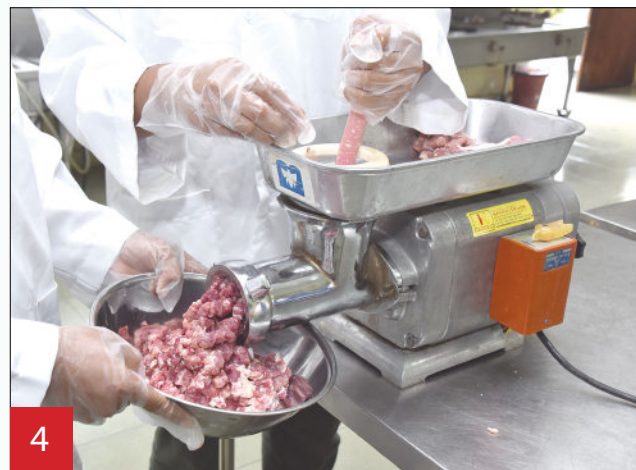
Kisar daging dengan menggunakan mincer (plat 5 mm).
