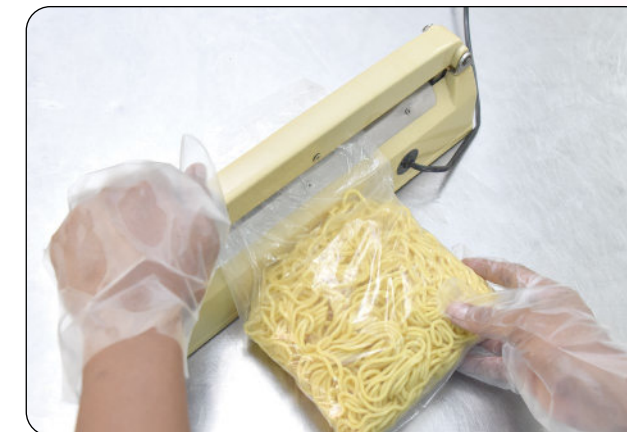
Keluarkan udara dalam plastik dan paterikan plastik.
