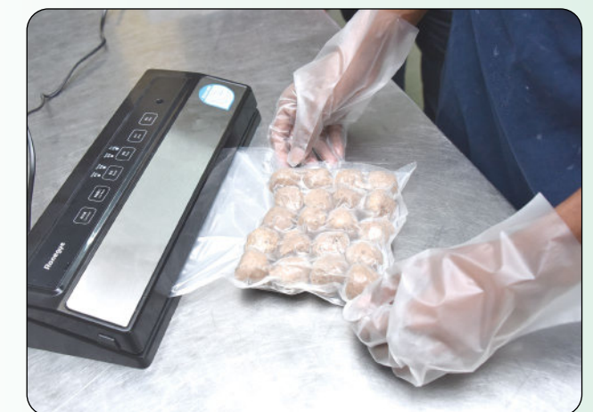
2 Bungkus dengan menggunakan pemateri vakum.
