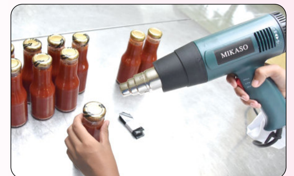
4 Lekatkan shrinked cap neck seal pada botol.
