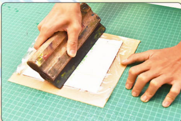
4 Meratakan permukaan vinil dengan menggunakan sekuji.
