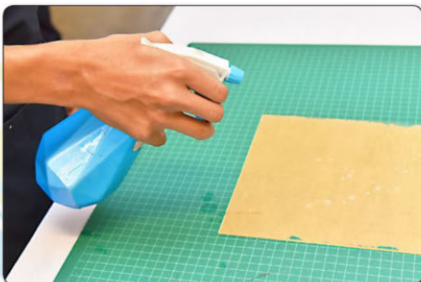
2 Menyembur air sabun pada permukaan panel akrilik.
