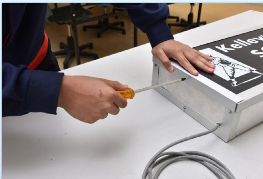
(b) Menutup ruang masuk panel dengan bingkai aluminium
