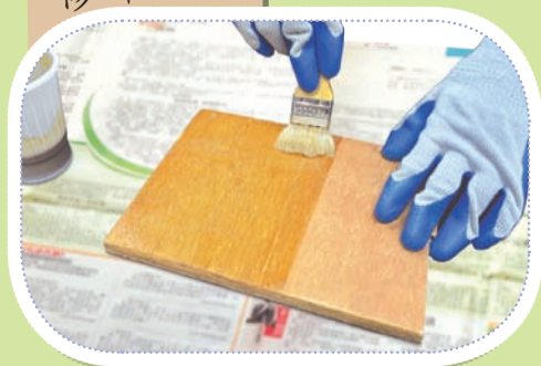
1 根据木纹，用砂纸磨木板表面，然后涂上虫胶。
