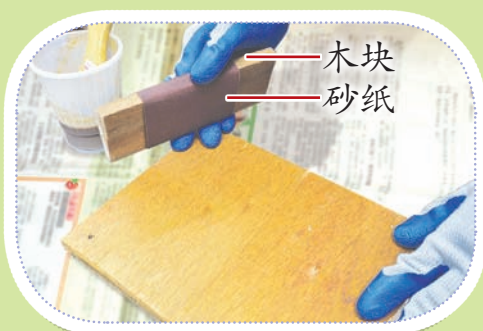
1 根据木纹，用砂纸磨木板表面，然后涂上虫胶。
